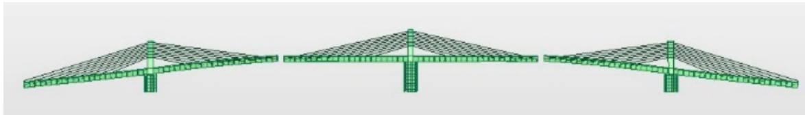
Figura 19. Modelo 3D extruido. Estado deformado incluyendo la contraflecha en la etapa antes de construir las dovelas de cierre.
