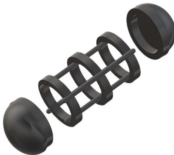
Figura 49: Estructura interna del Merry II - Fuente propia.
