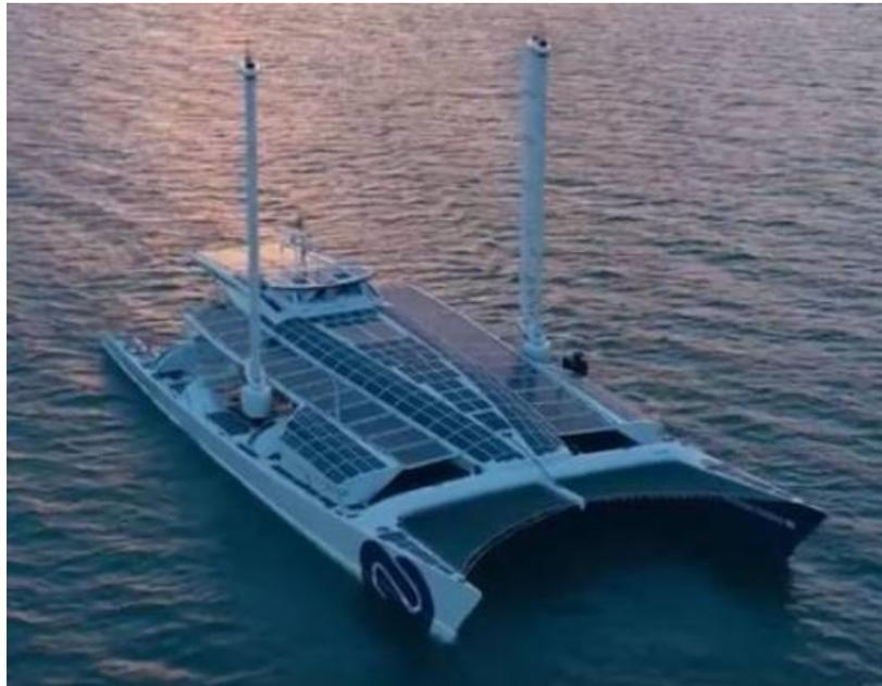
Figura 1: Barco que funciona con energía solar y energía del hidrógeno del agua de mar - Betch.
