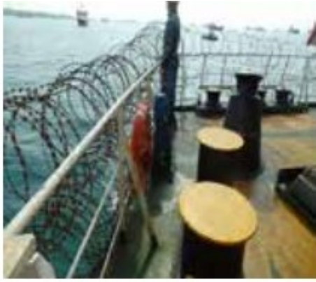
Figura 29: Alambre de espino en la popa un buque. Fuente: BMP5
