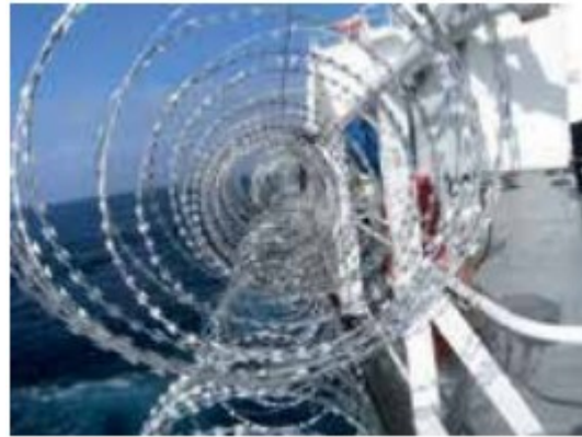
Figura 28: Alambre de espino en el costado de un buque. Fuente: BMP5
