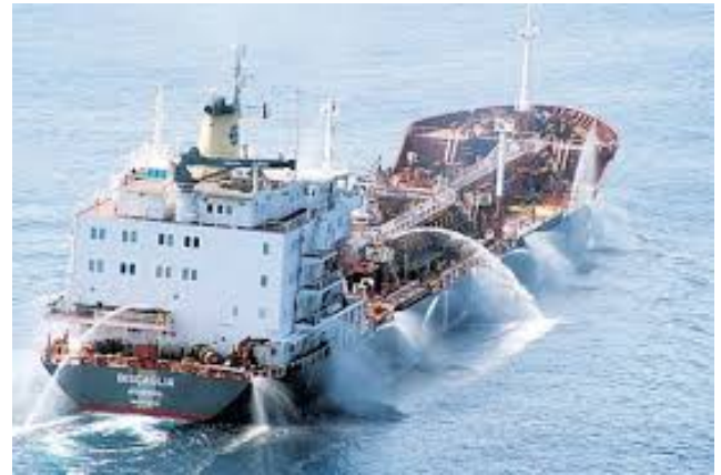
Figura 24: Buque con cañones de agua como defensa contra la piratería. Fuente: Universidad de La Laguna.
