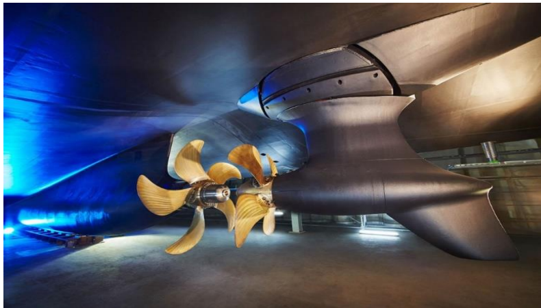
Figura 26: Instalación de hélice principal única en la línea central y un propulsor azimutal en línea, del super yate híbrido Savannah. [46]
