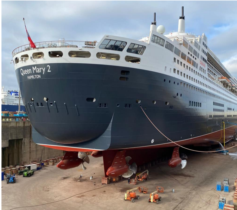
Figura 17: El Queen Mary 2 está equipado con cuatro Pod Mermaid, dos fijos situados a proa de los dos pod azimutales que le dan gobierno al buque. Fuente propia.
