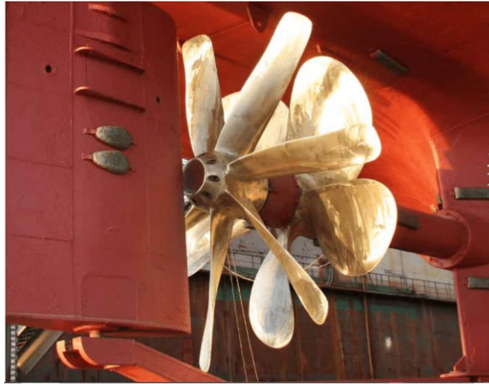
Figura 19: Rueda de paleta de rotación libre detrás de la hélice principal (2012). Fuente: DNV GL/HHI [37]
