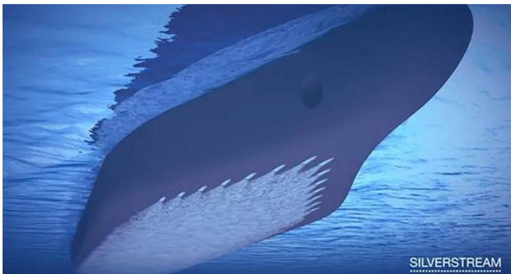
Figura 30: Tecnología de lubricación por aire, sistema Silverstream®. Fuente: Wartsila [51]
