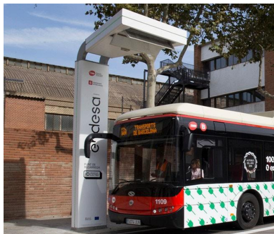
Il·lustració 14: Carregador ultra ràpid pantògraf instal·lat per Endesa.
