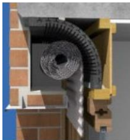
Il·lustració 34. Panell flexible multicapa que s'introdueix dins la caixa de persianes per millorar ponts tèrmics
