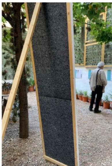
Il·lustració 39. Trasdossat amb bastidor de fusta i mascaretes reciclables com a aïllament
