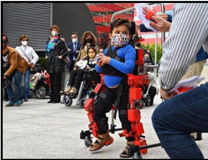
Imagen 19: Exoesqueleto ATLAS 2030 (Fuente: INFOSALUS, Asistencia, 2021).
