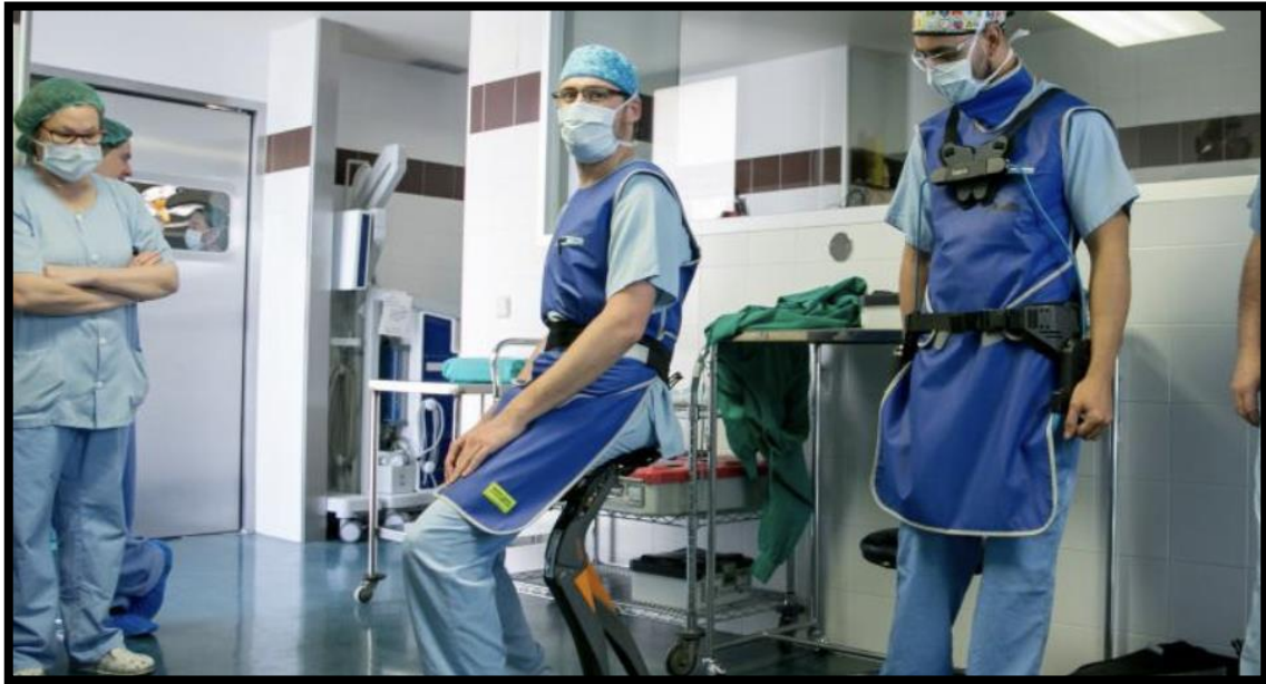
Imagen 14: Exoesqueleto Chairless Chair utilizado en el Hospital Clínico de Zaragoza (Fuente: Heraldo, Sanidad, “Médicos del Clínico pioneros en operar con exoesqueletos para reducir esfuerzo y evitar lesiones”, 2019 ).
