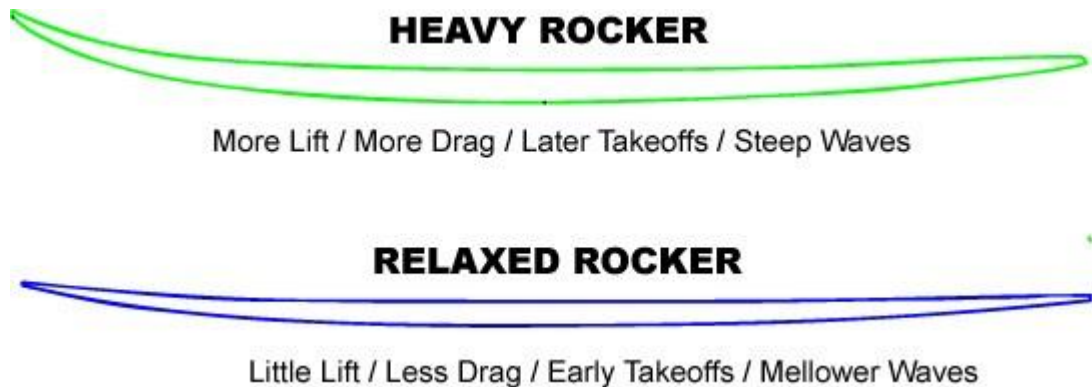
Figura 4: Perfils de taula de paddle surf
