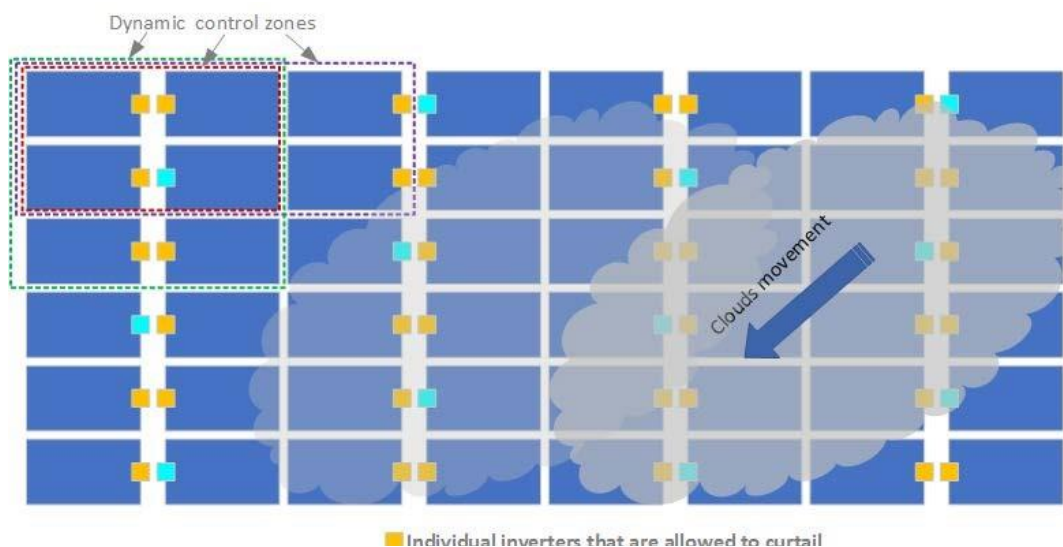
Figura 11. Esquema de planta fotovoltaica dividida en sus zonas de control [11]
