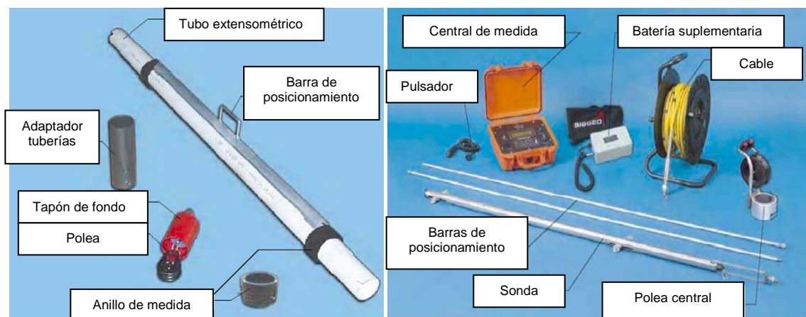
Figura 3.18 Foto de una tubería extensométrica incremental y accesorios
