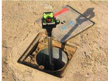
Figura 3.16 Foto del prisma de lectura sobre cabeza de un hito de combinado
