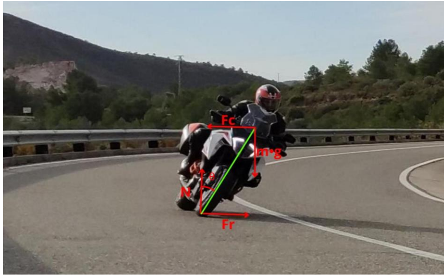
Figura 34: Esquema de los esfuerzos que recibe la motocicleta durante una curva
