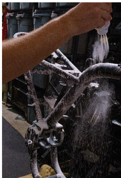
Figura 17: Aumentando la visibilidad del chasis en el escaneo con talco
