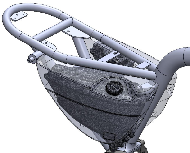
Figura 20: Mallado del depósito de aceite con la tapa encima
