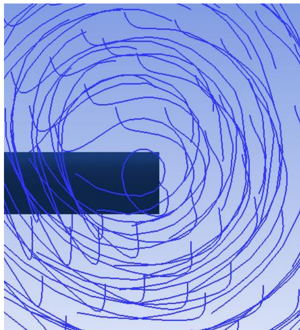
FIGURA 46. VÓRTICE GENERADO EN EL EXTREMO DEL PERFIL SIN DERIVA LATERAL.
