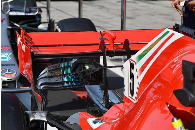
FIGURA 10. ALERÓN MULTIELEMENTOS EN FÓRMULA 1. (FUENTE: MOTORSPORT) [10]
