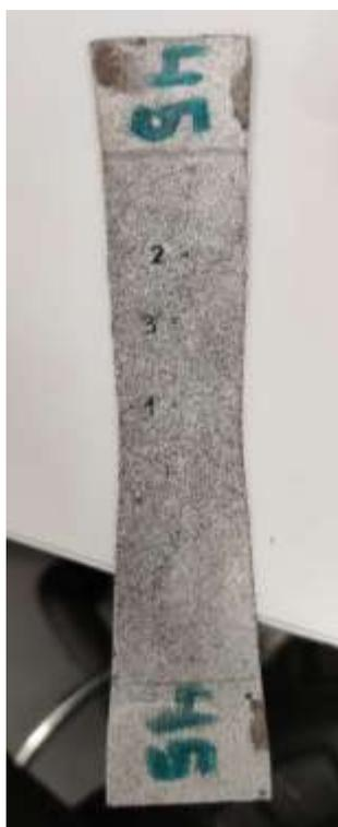
Ilustración 19.- Puntos de medida en la probeta deformada a 45%
