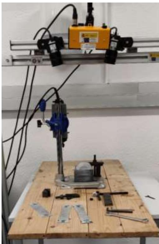
*Ilustración 27.- Montaje utilizado en las probetas laminadas para el método de "hole-drilling" con DIC*
