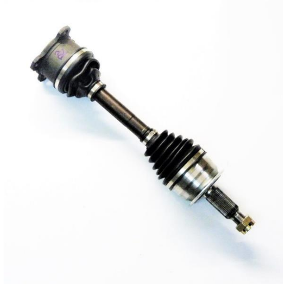
Il·lustració 8: Palier o semi-arbre de transmissió[Font 9]
