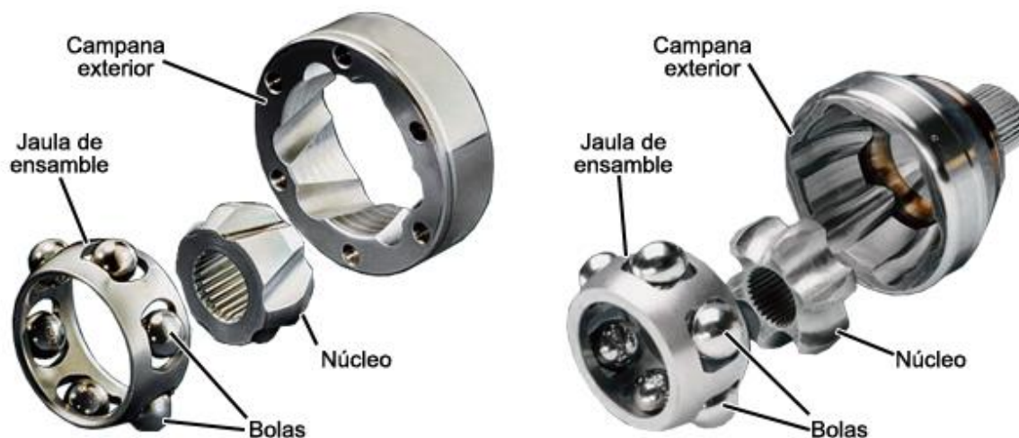
Il·lustració 11: Components de una junta homocinètica [Font 14]
