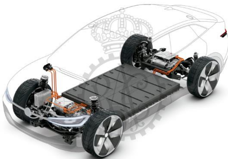
Il·lustració 1: Ubicació de la bateria en un cotxe elèctric[Font 9]
