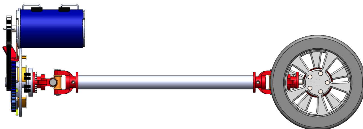
Il·lustració 50: Vista lateral del sistema de transmissió complet[Font pròpia]
