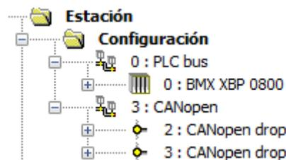
Figura 20 : Configuración de hardware del proyecto de la línea CAN
