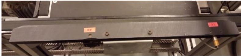
Figura 16 : Sensor inductivo basculante en plataforma
