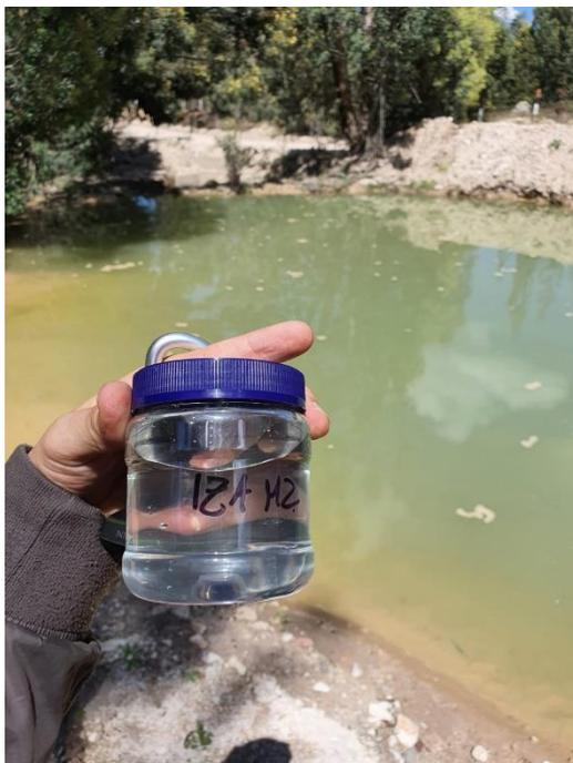
**Fotografía #2.1.** Toma de Muestra "M2" en drenaje Terciario tomado aguas debajo de la Muestra "M1"
