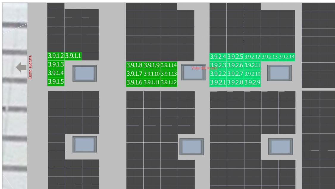
Figura segundo anexo 50 MPPT9 Inversor 3
