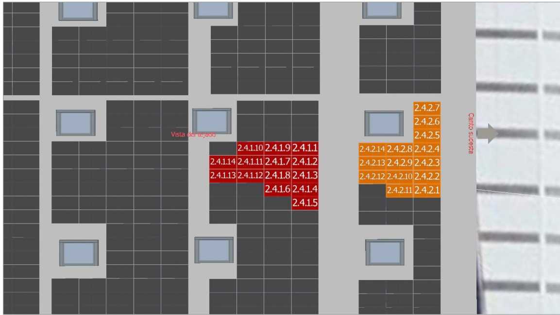
Figura segundo anexo 36 MPPT4 Inversor 2
