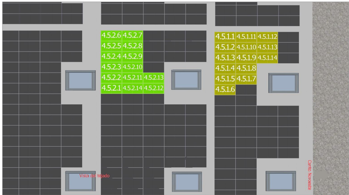
Figura segundo anexo 55 MPPT5 Inversor 4
