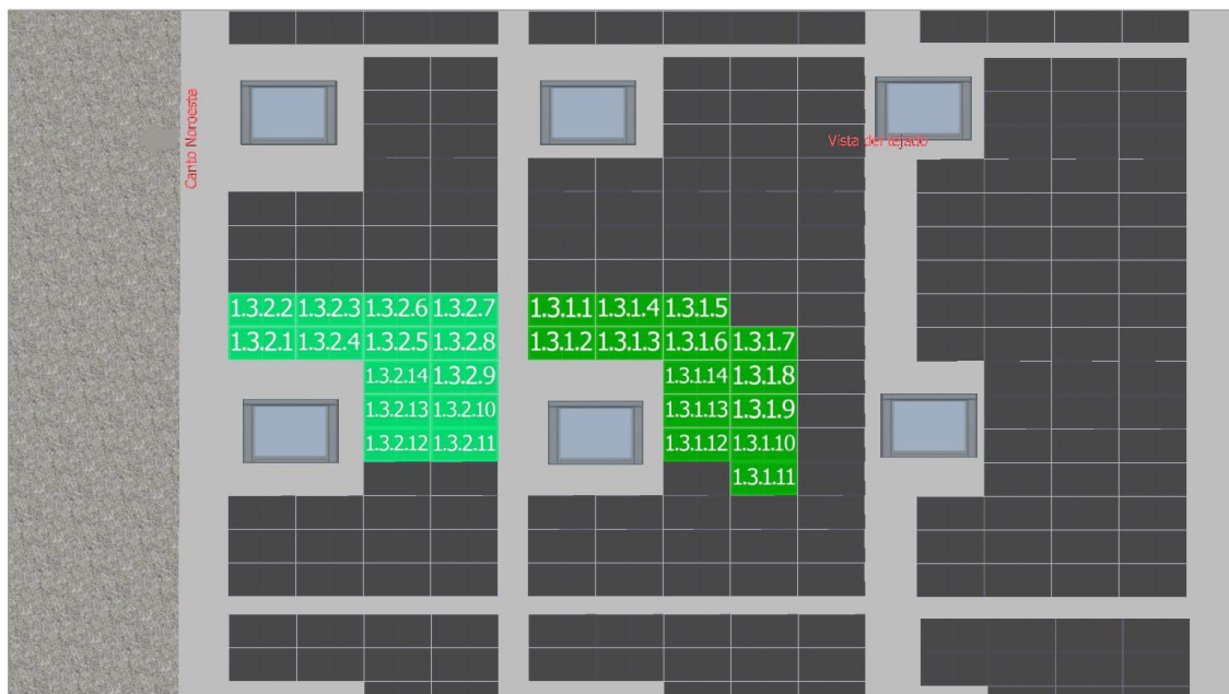
Figura segundo anexo 26 MPPT3 Inversor 1
