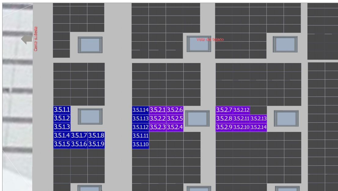
Figura segundo anexo 46 MPPT5 Inversor 3
