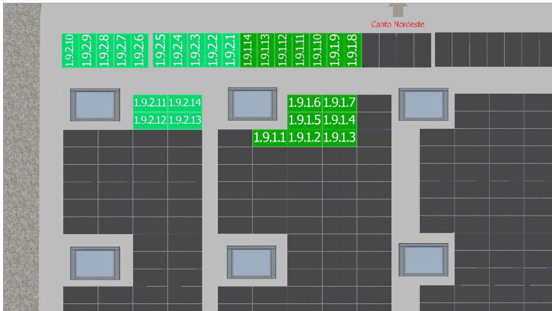
Figura segundo anexo 32 MPPT9 Inversor 1
