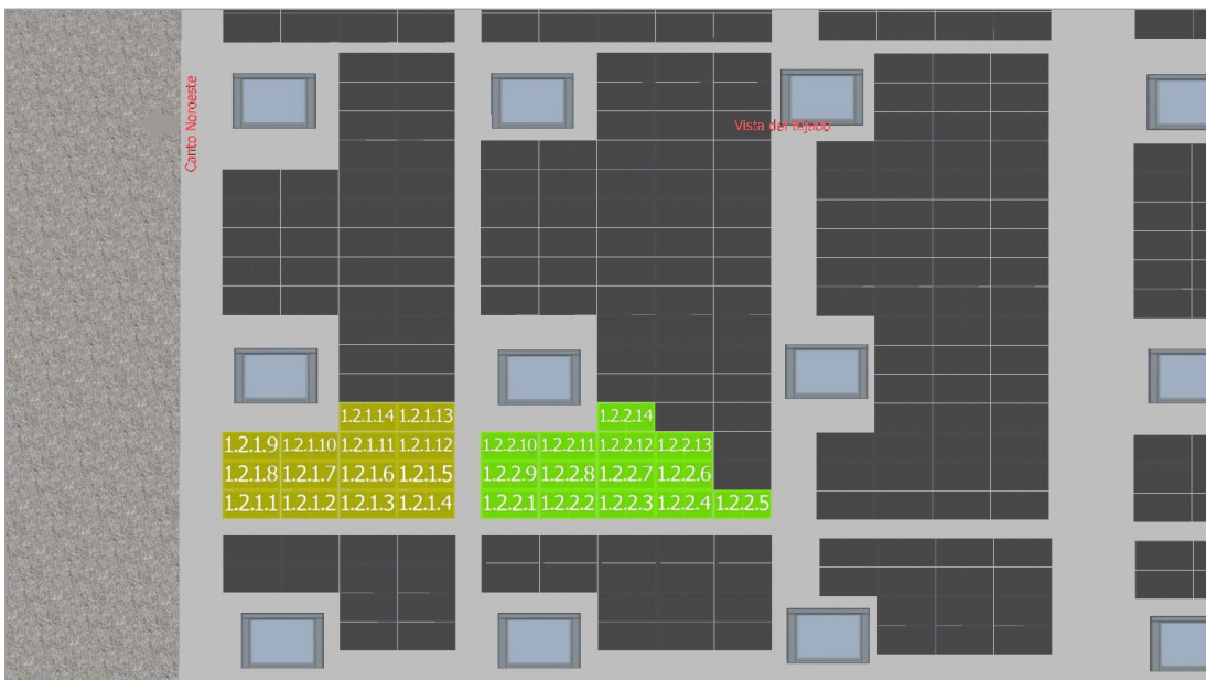
Figura segundo anexo 25 MPPT2 Inversor 1
