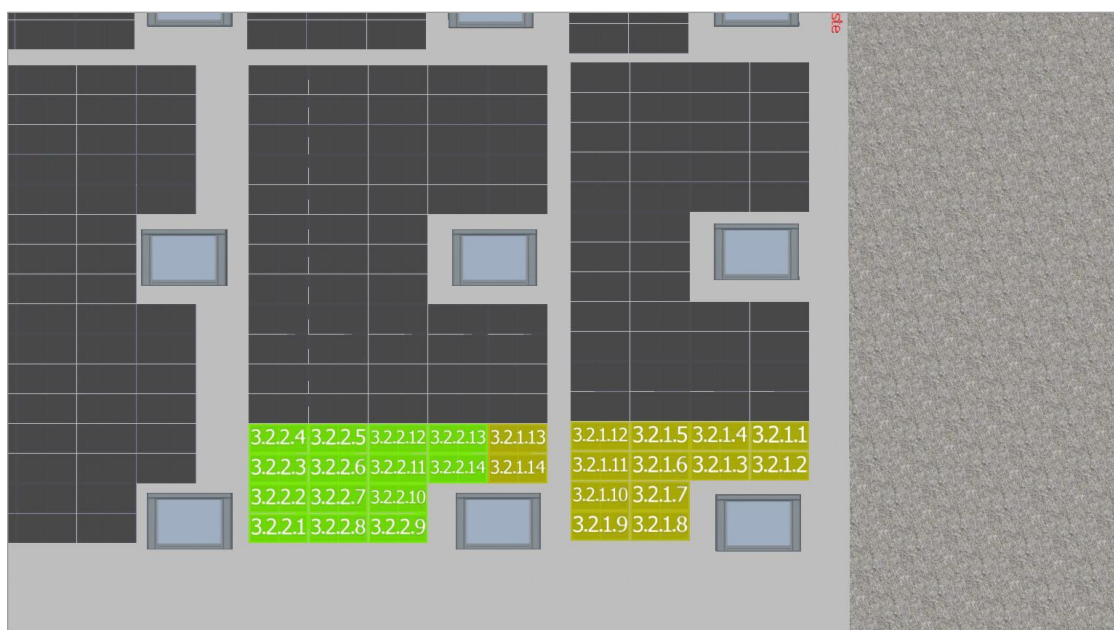
Figura segundo anexo 43 MPPT2 Inversor 3
