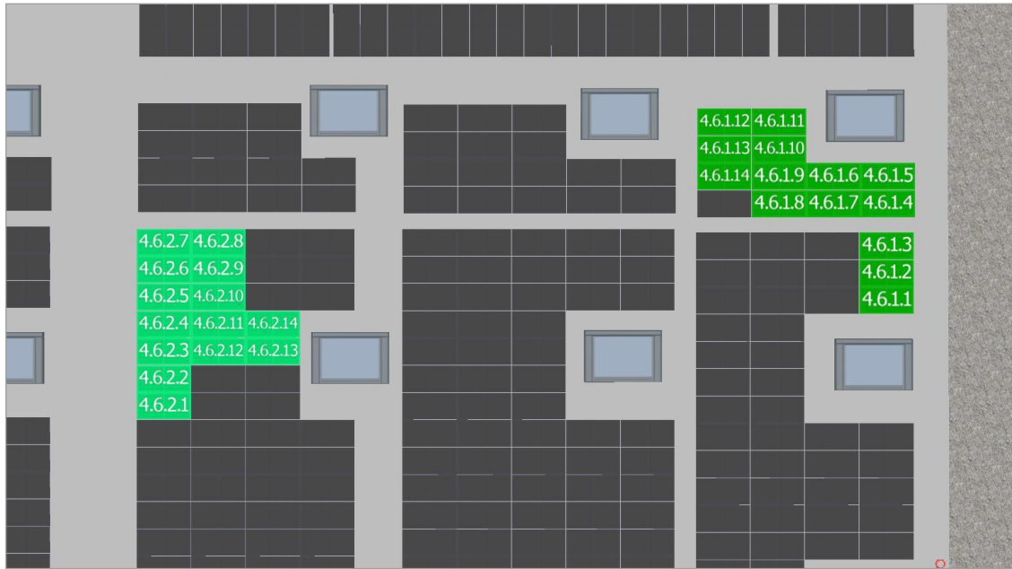
Figura segundo anexo 56 MPPT6 Inversor 4
