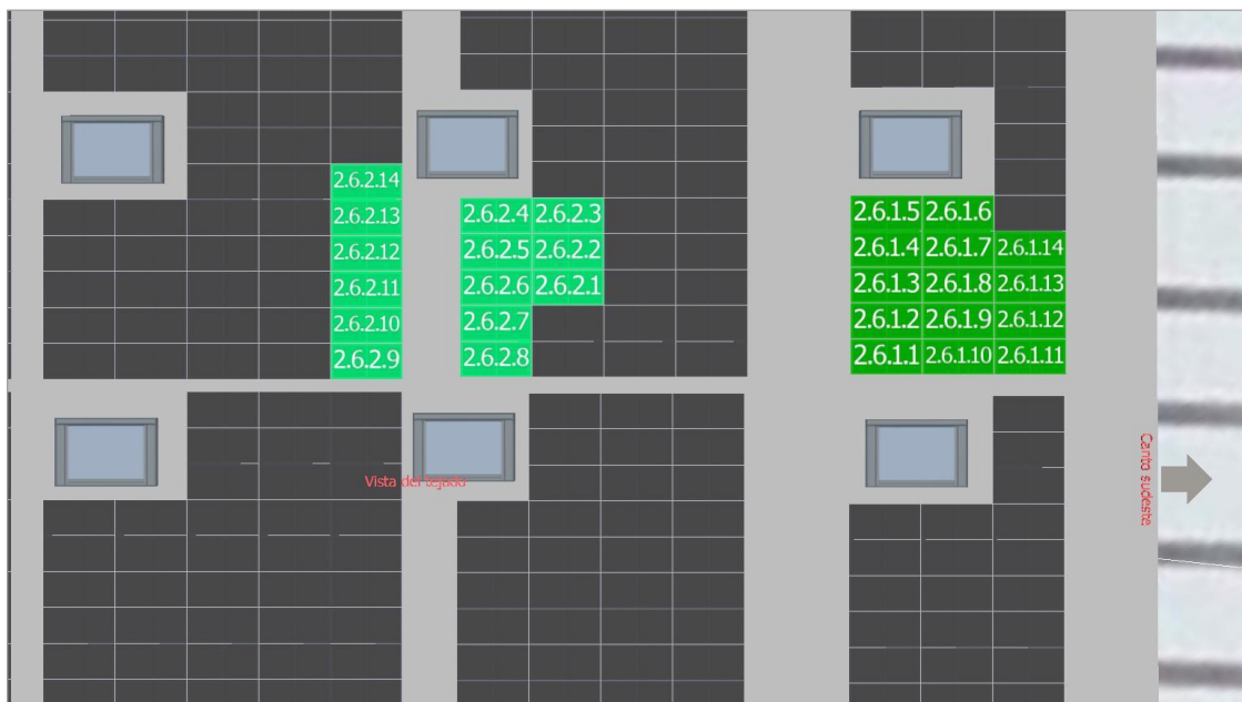
Figura segundo anexo 38 MPPT6 Inversor 2
