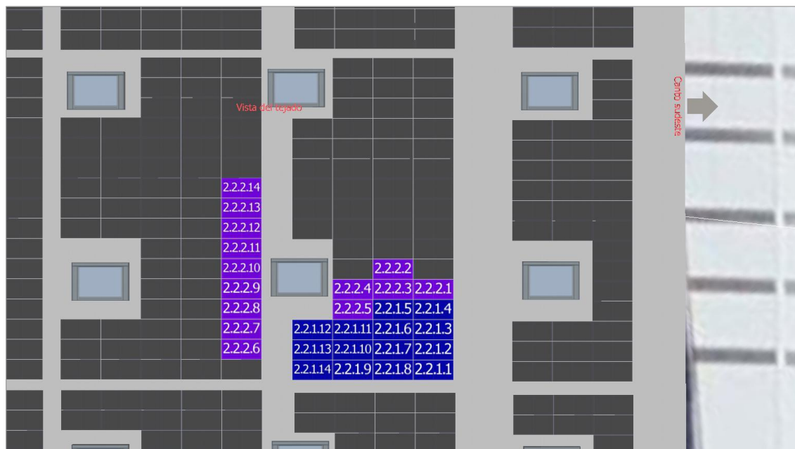
Figura segundo anexo 34 MPPT2 Inversor 2
