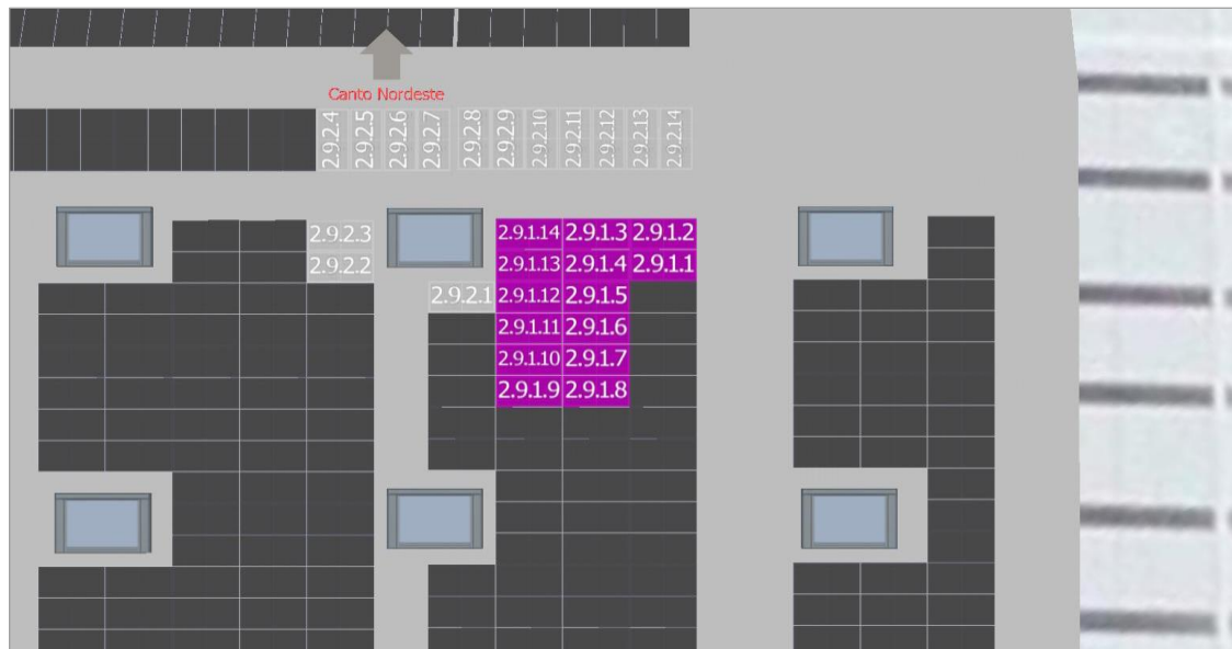
Figura segundo anexo 41 MPPT9 Inversor 2
