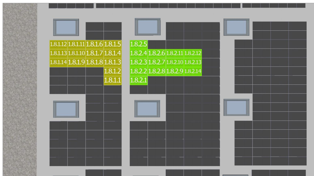
Figura segundo anexo 31 MPPT8 Inversor 1
