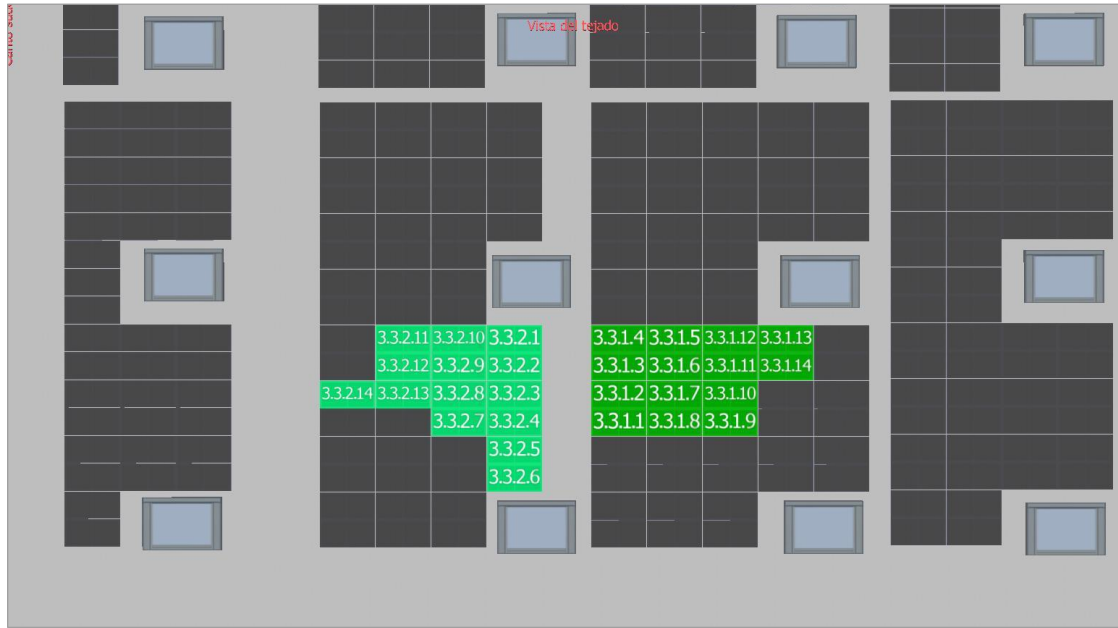
Figura segundo anexo 44 MPPT3 Inversor 3
