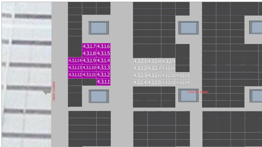
Figura segundo anexo 53 MPPT3 Inversor 4
