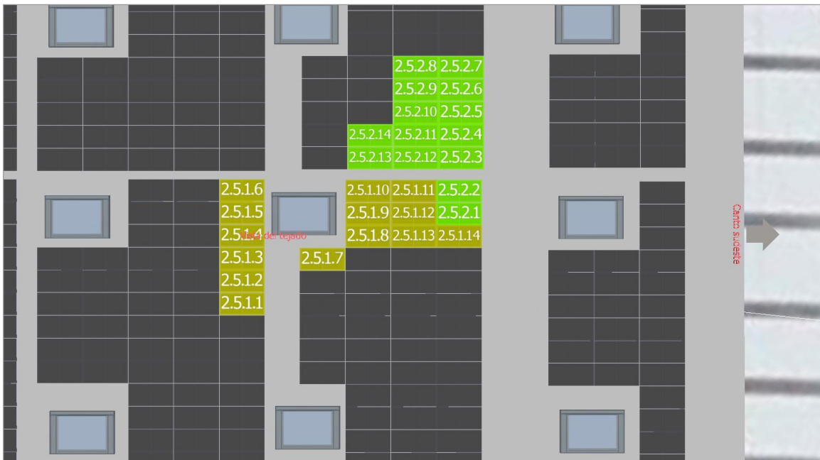
Figura segundo anexo 37 MPPT5 Inversor 2
