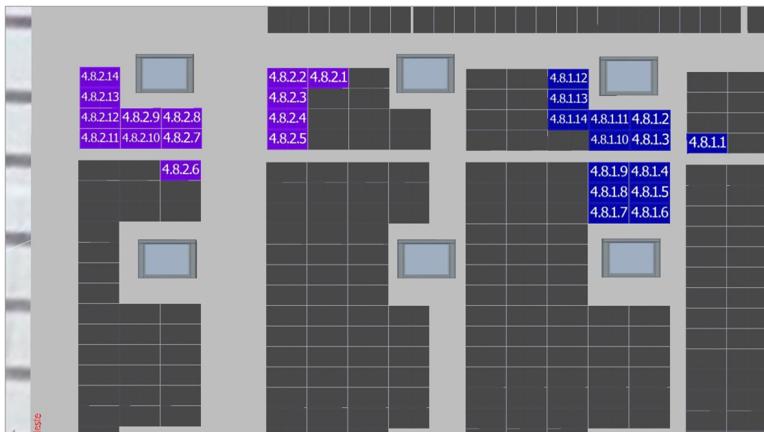
Figura segundo anexo 58 MPPT8 Inversor 4
