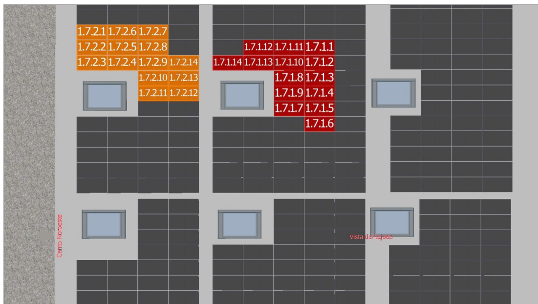
Figura segundo anexo 30 MPPT7 Inversor 1
