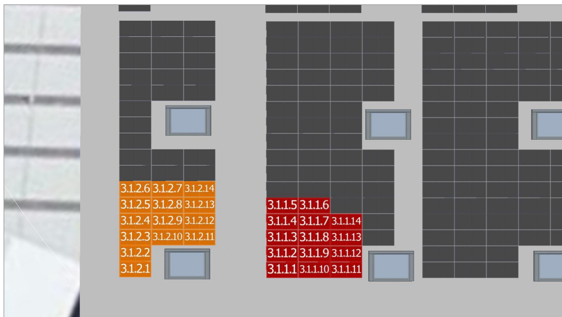
Figura segundo anexo 42 MPPT1 Inversor 3
