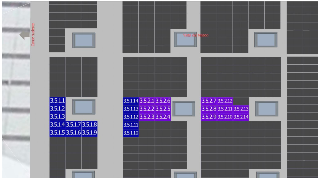
Figura segundo anexo 46 MPPT5 Inversor 3
