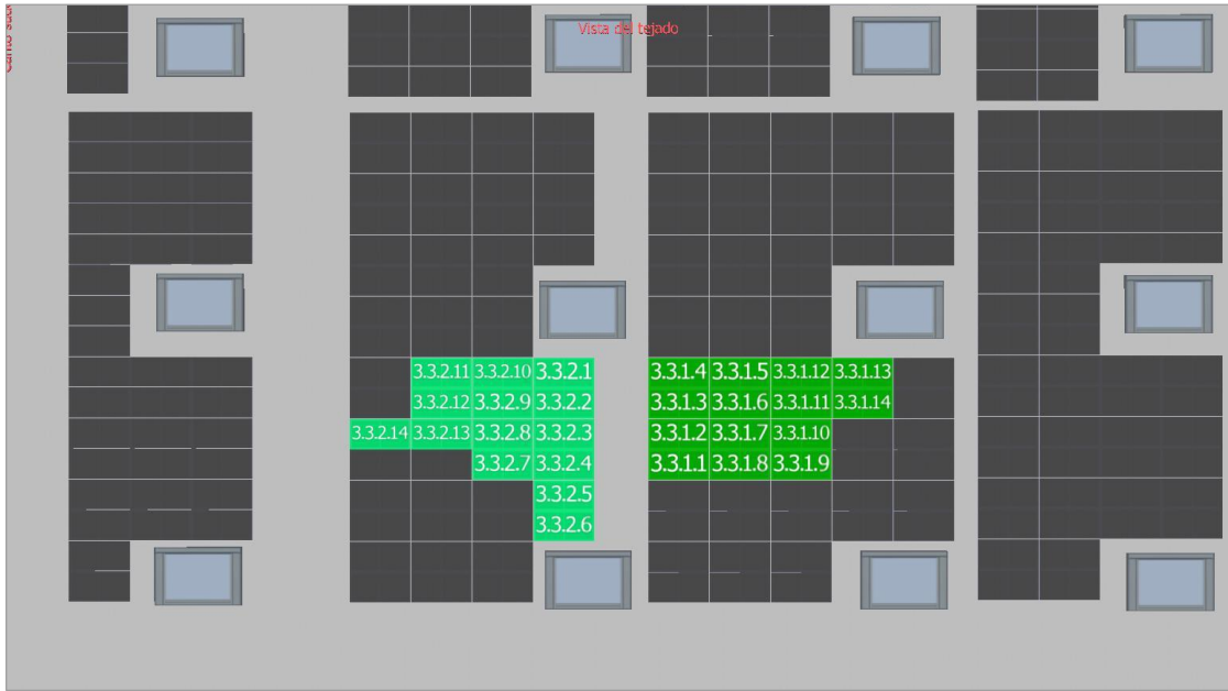
Figura segundo anexo 44 MPPT3 Inversor 3
