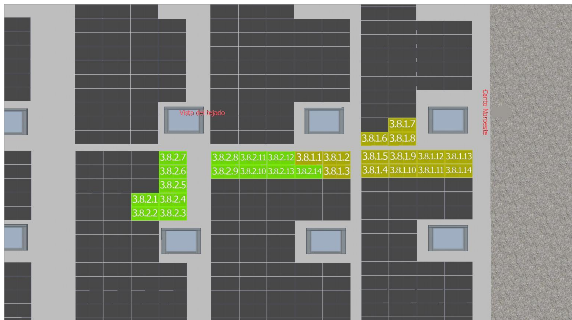
Figura segundo anexo 49 MPPT8 Inversor 3
