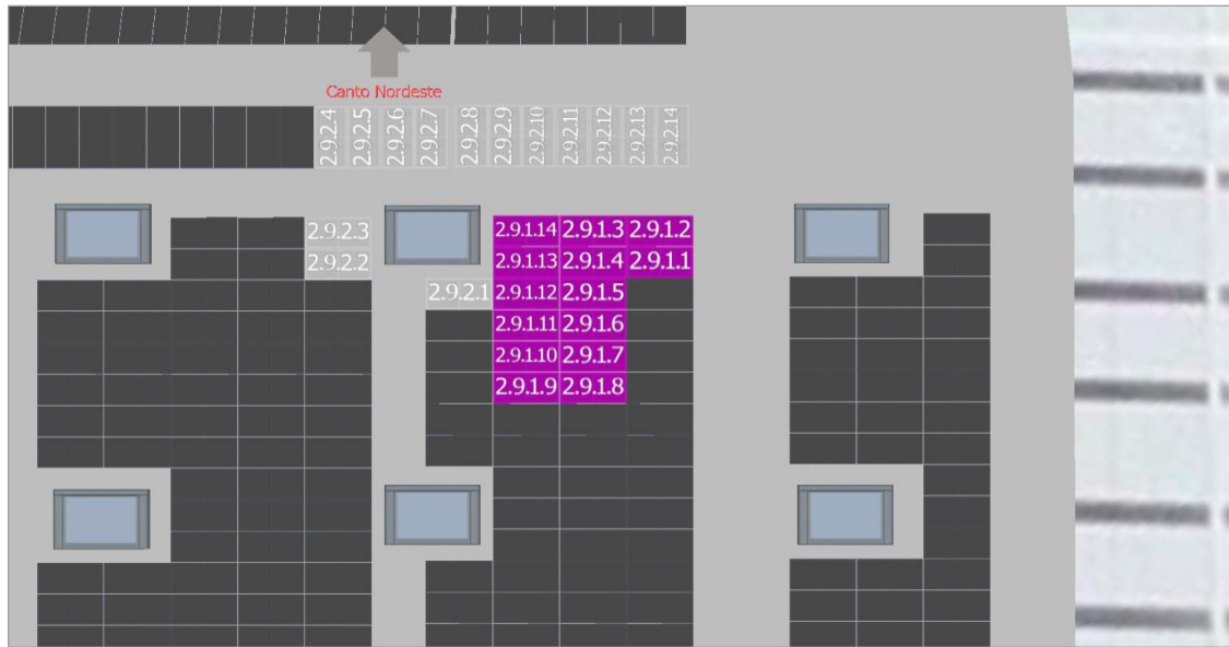
Figura segundo anexo 41 MPPT9 Inversor 2
