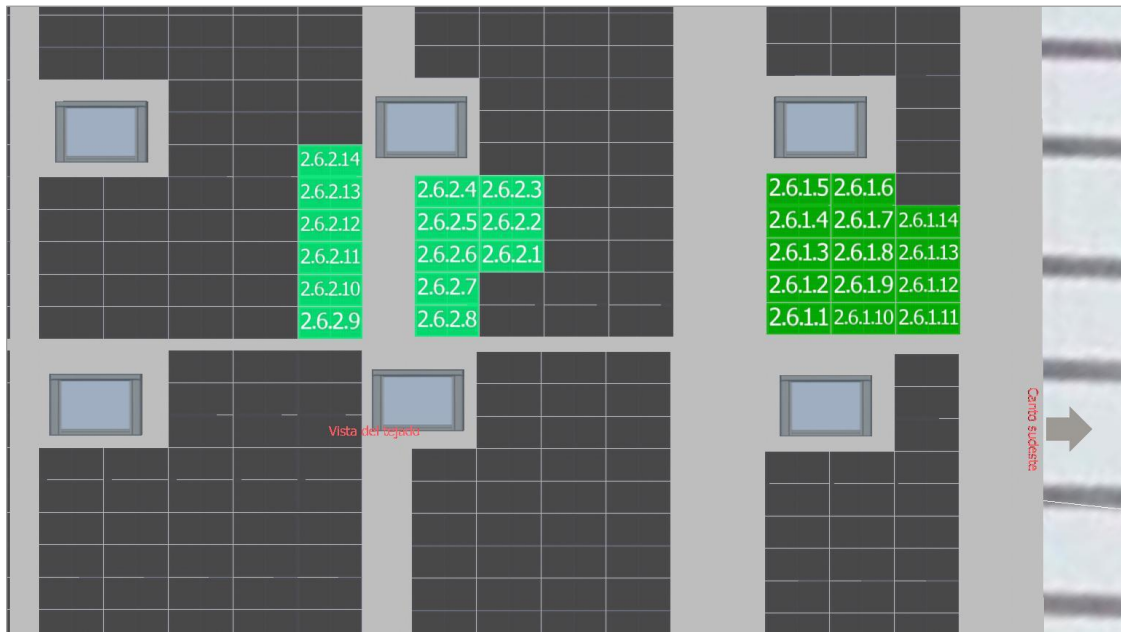
Figura segundo anexo 38 MPPT6 Inversor 2
