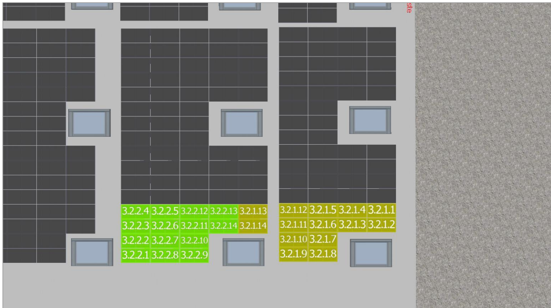
Figura segundo anexo 43 MPPT2 Inversor 3
