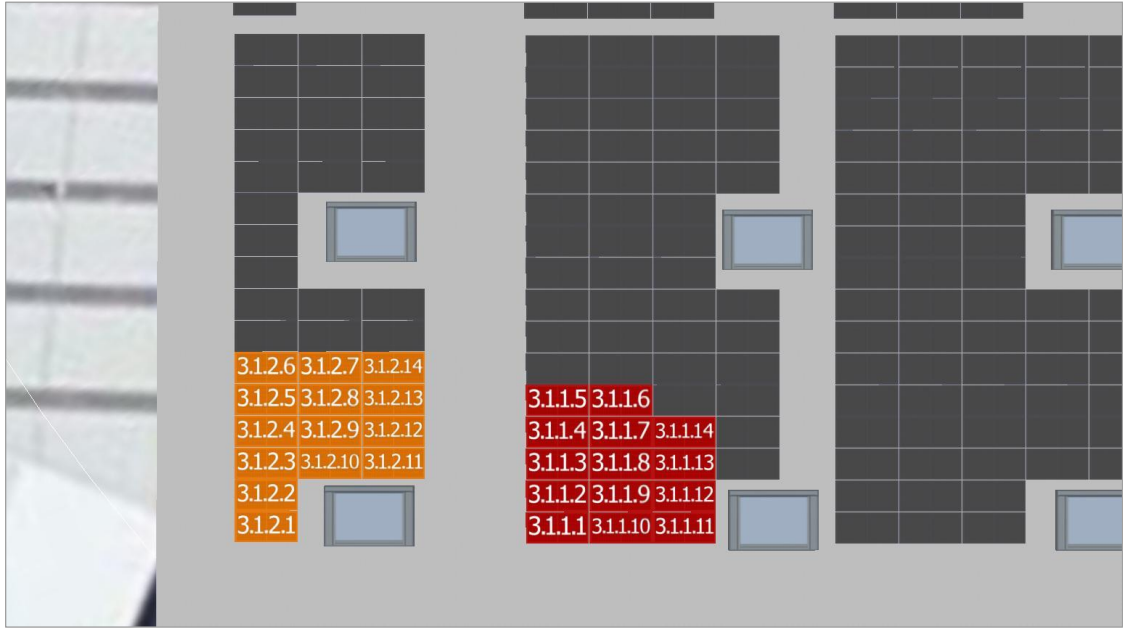
Figura segundo anexo 42 MPPT1 Inversor 3
