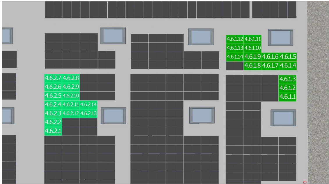
Figura segundo anexo 56 MPPT6 Inversor 4
