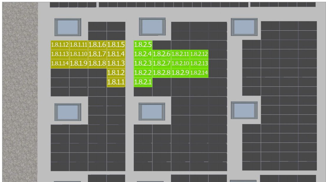
Figura segundo anexo 31 MPPT8 Inversor 1
