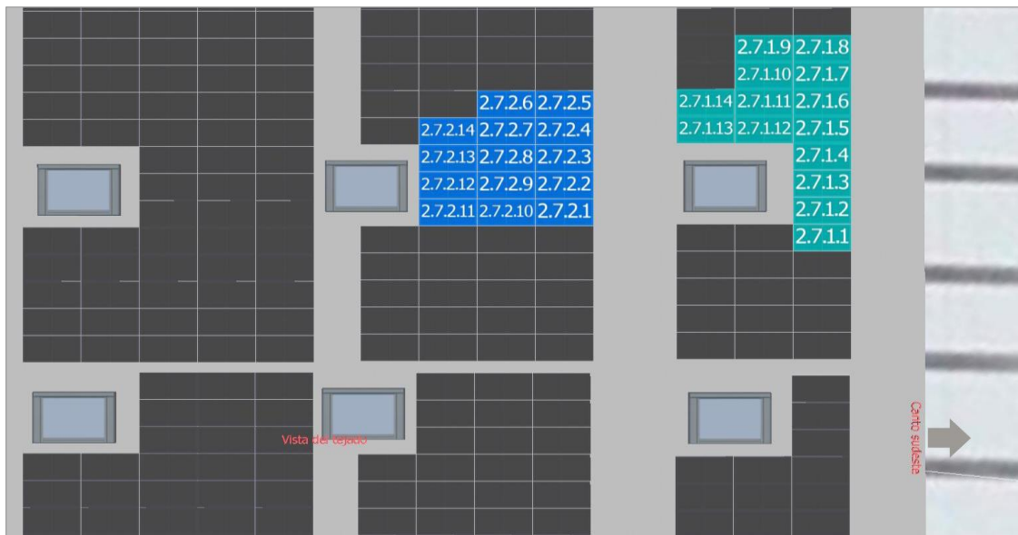
Figura segundo anexo 39 MPPT7 Inversor 2
