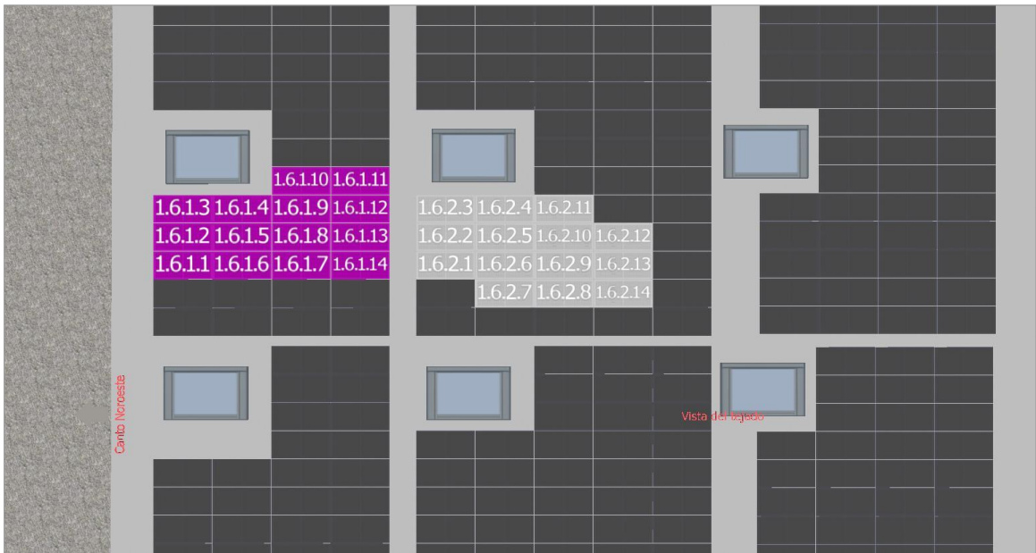
Figura segundo anexo 29 MPPT6 Inversor 1
