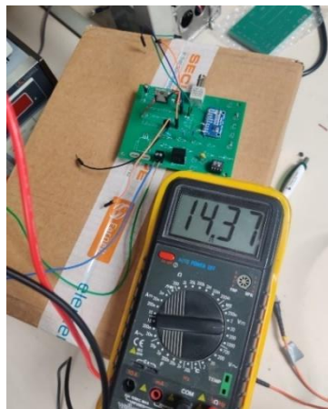
Figura 58. Mesura d'alimentació. El nostre sistema sotmés a un voltatge de 14.37V. Arrodonim a 14.4V
