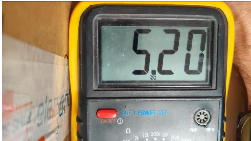
Figura 59. Mesura al divisor de tensió. Valor obtingut al col·locar el voltímetre al node del divisor de tensió i a massa.
