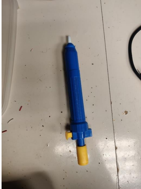
Figura 8. Dessoldador mecànic de succió
