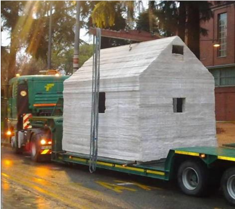
Figura 17 Una casa hecha de una sola pieza con D-shape
