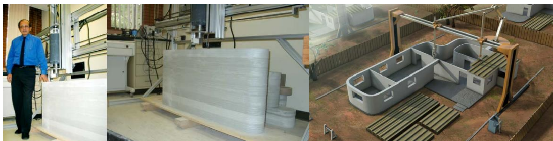
Figura 11 (Izquierda) Khoshnevis y su impresora CC. Figura 12 (derecha) Propuesta de impresora CC a gran escala.
