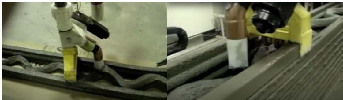
Figura 14. Detalle de las partes de la boquilla utilizada en CC.
