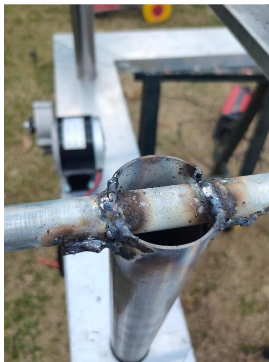
Ilustración 43.- Soldadura de barra para ejes. [Fuente Propia]
