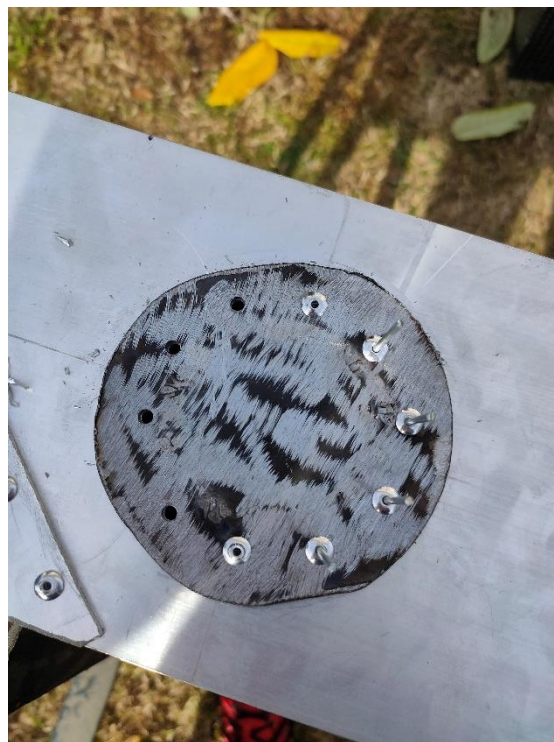
Il·lustració 40.- Remachado del pilar. [Fuente Propia]
