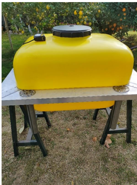
Il·lustració 41.- Base con pilares. [Fuente Propia]
