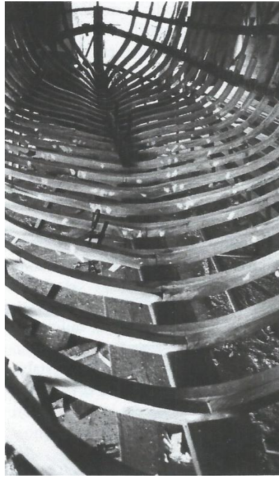
Il·lustració 4: Detall d'un llaüt en construcció a la drassana dels March. Font: Arxiu familiar March
