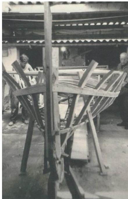
Il·lustració 5: El mestre d'aixa Antoni Munar Boliquet en la construcció d'un llaüt. Font: Arxiu d'Antoni Munar
