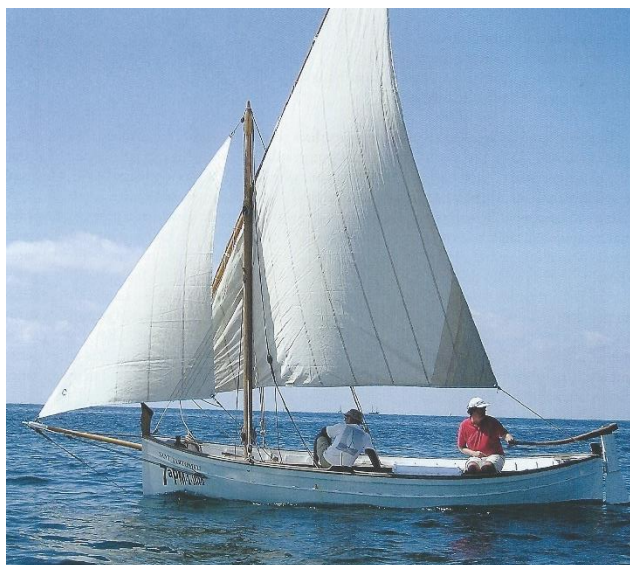
Il·lustració 11: Llaüt Sant Bartomeu aparellat amb un arbre a un quart i floc. Font: Antoni Jover
