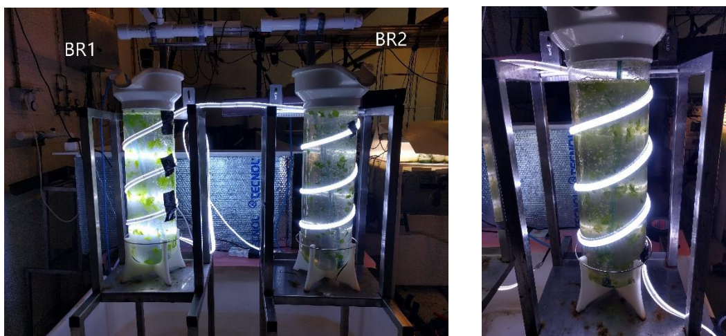
Fig 13: Fotobioreactors utilitzats per els diferents cultius d' Ulva ohnoi (Fotografia realitzada per Gerard del Álamo Gaus, EEABB, UPC Castelldefels).
