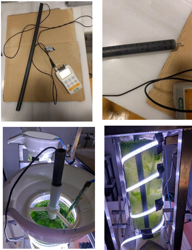
Fig 17: sonda ULM-500 i procés d'obtenció dels valors de radiació PAR en el BR2 (Fotografia realitzades per Gerard del Álamo Gaus, EEABB, 2021)
