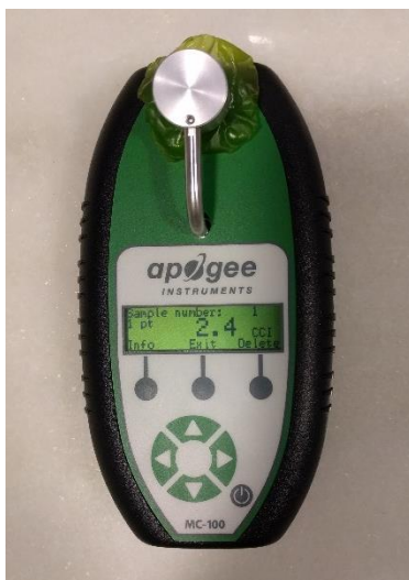
Fig 16: MC-100 Chlorophyll Concentration Meter, amb exemple de determinació de clorofil·la d'un fragment d'alga. (Fotografia realitzades per Gerard del Álamo Gaus, EEABB, 2021)
