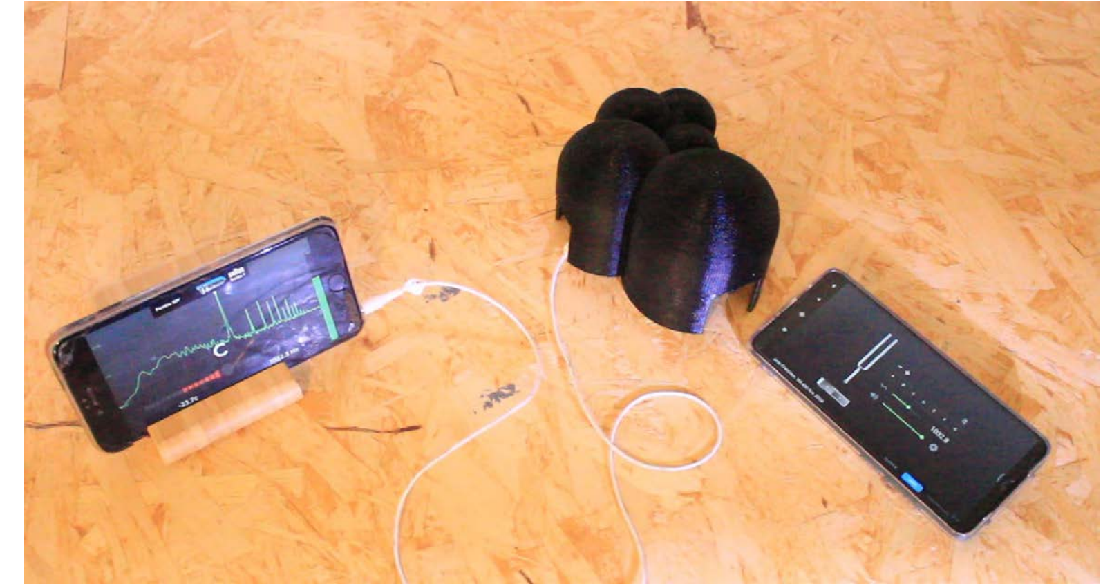
Prueba sonora a maqueta de las 5 cúpulas de Islandia
