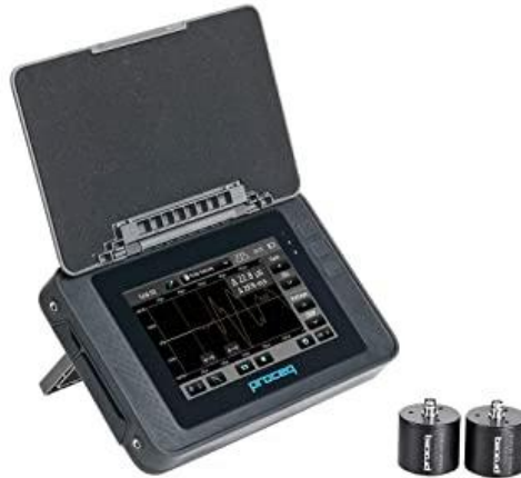
Figura 20. Aparato de Ultrasonidos Pundit PL-200.
