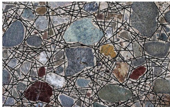
Figura 2.11: Muestra del hormigón reforzado con fibras metálicas. (Singh, 2017)
