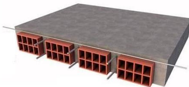
Figura 2.5: Forjado aligerado compuesto de hormigón armado y ladrillo. (Huánuco Construye, 2015)
