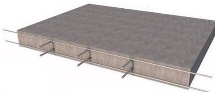
Figura 2.3:Forjado macizo.(Huánuco Construye, 2015)
