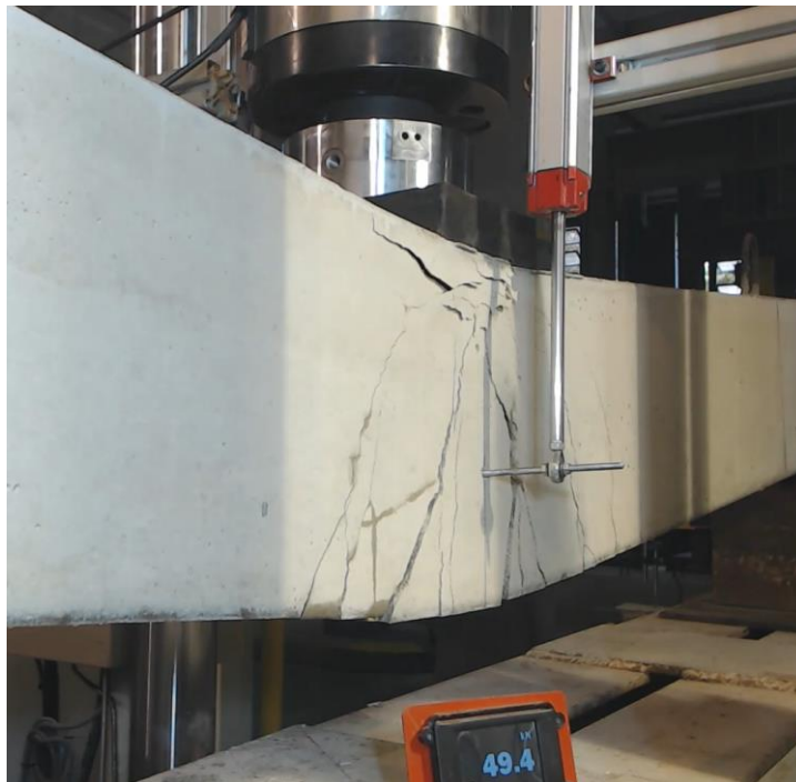
Figura 58. Fisuras Viga 4A10 a 49,4 kN. Grupo 1.
