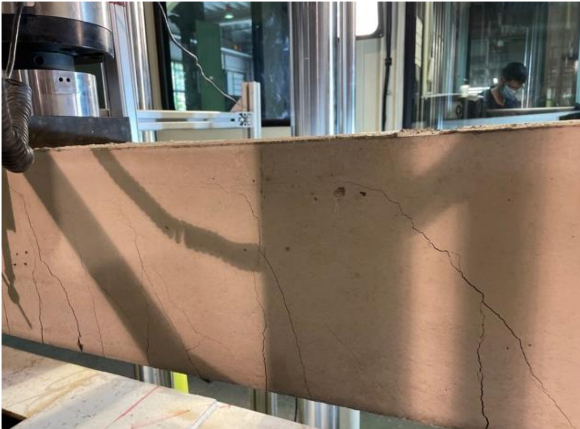
Figura 70. Fisuras cortantes de la Viga 3V13 a 51,8 kN. Grupo 2.
