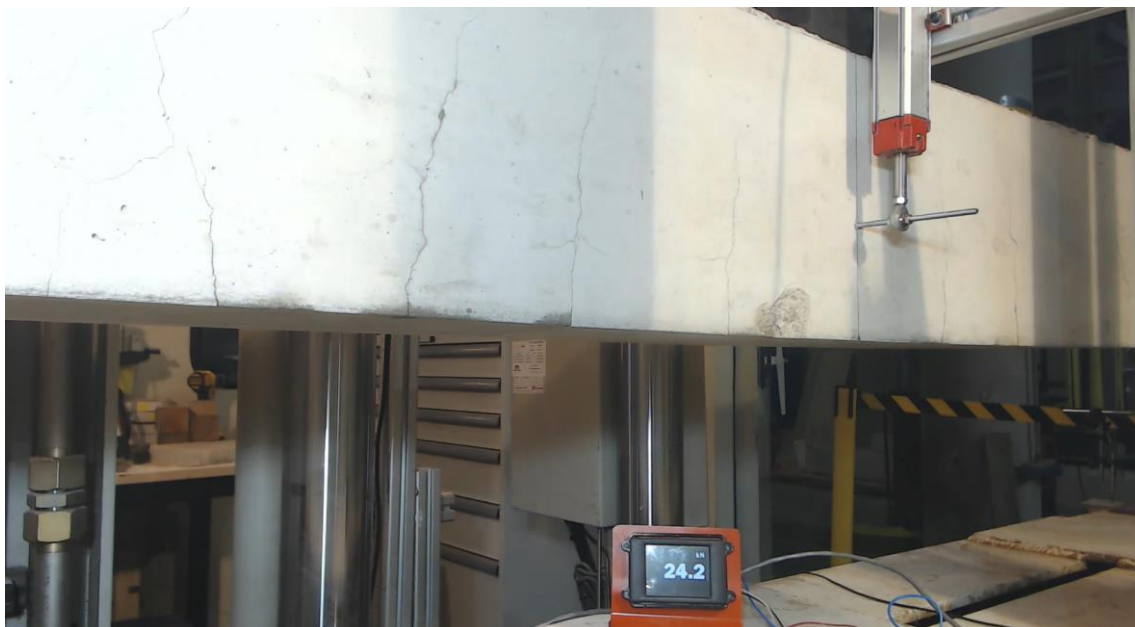
Figura 60. Fisuras Viga 2V10 a 24,2 kN, Grupo 1.
