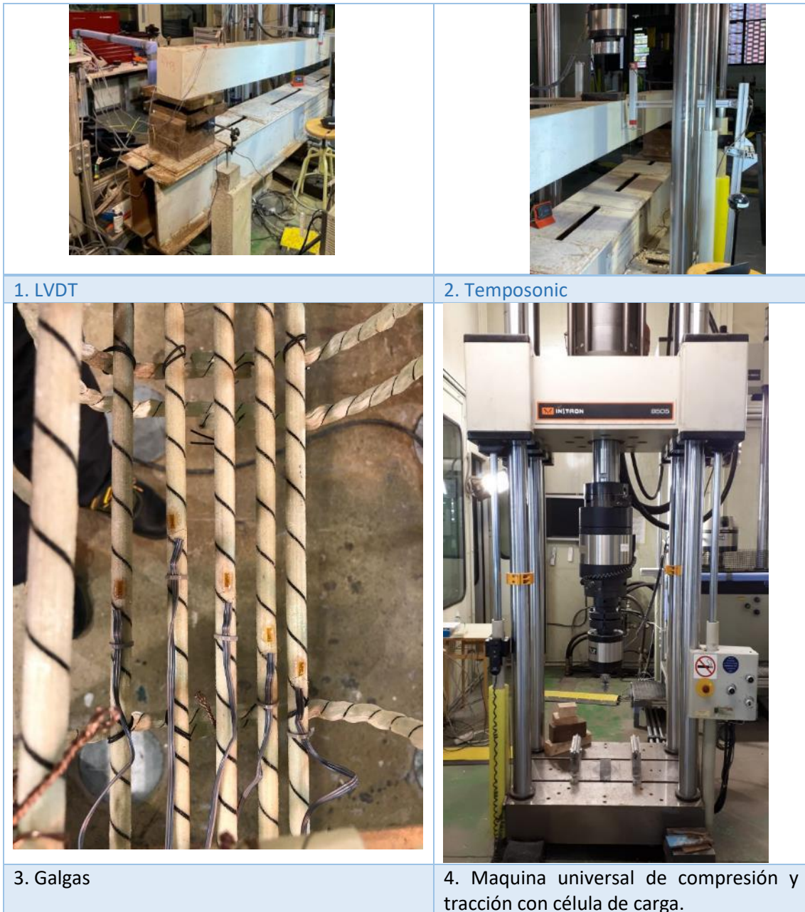
Figura 38. Imágenes detalle de los instrumentos utilizados durante los ensayos con armadura pasiva
