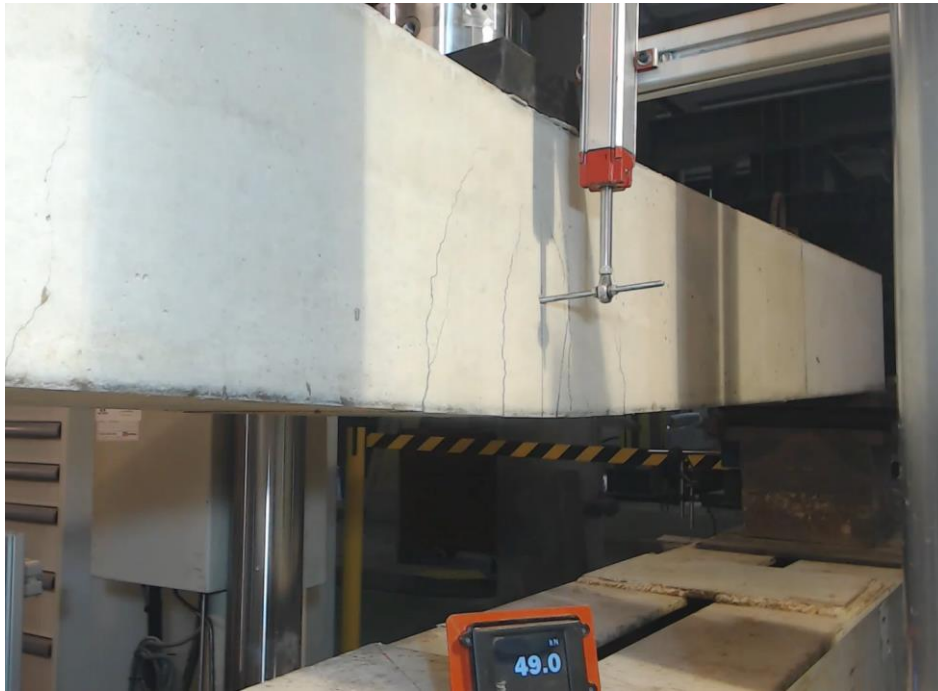
Figura 57. Fisuras Viga 4A10 a 49 kN. Grupo 1.
