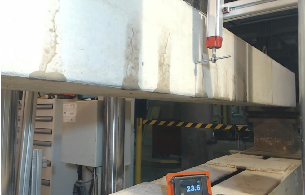
Figura 55. Fisuras Viga 4A10 a 23,6kN. Grupo 1.
