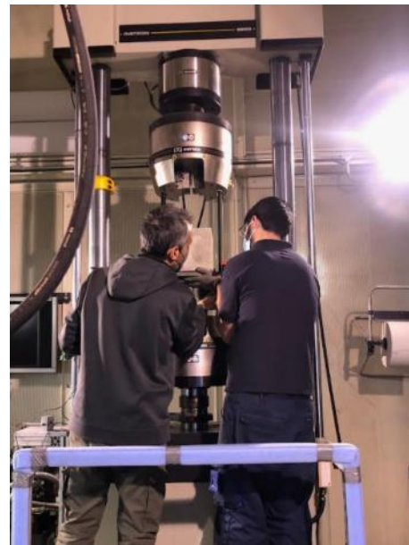
Figura 6. Fotografía realizada insitu del ensayo Pull-out. Fuente: propia
