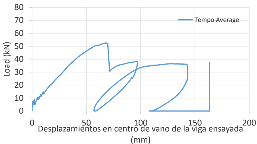
Figura 101. Gráfica Desplazamientos de la viga ensayada, en centro de vano. Viga 5V10
