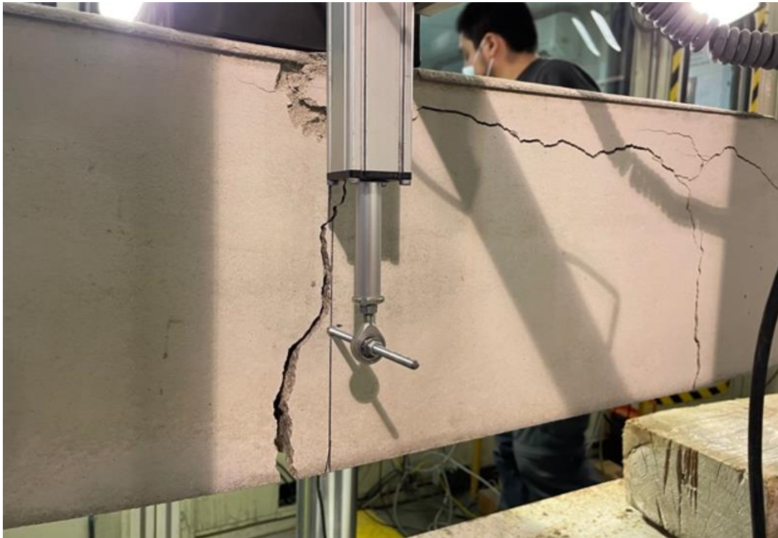
Figura 64. Fisuras Viga 2T13a a carga de rotura, Grupo 1.
