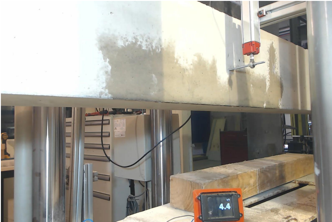
Figura 74. Fisuras Viga 3T13b a 4,4kN. Grupo 2.
