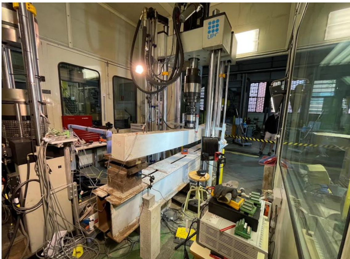
Figura 35. Situación de la viga en el ensayo de armadura pasiva
