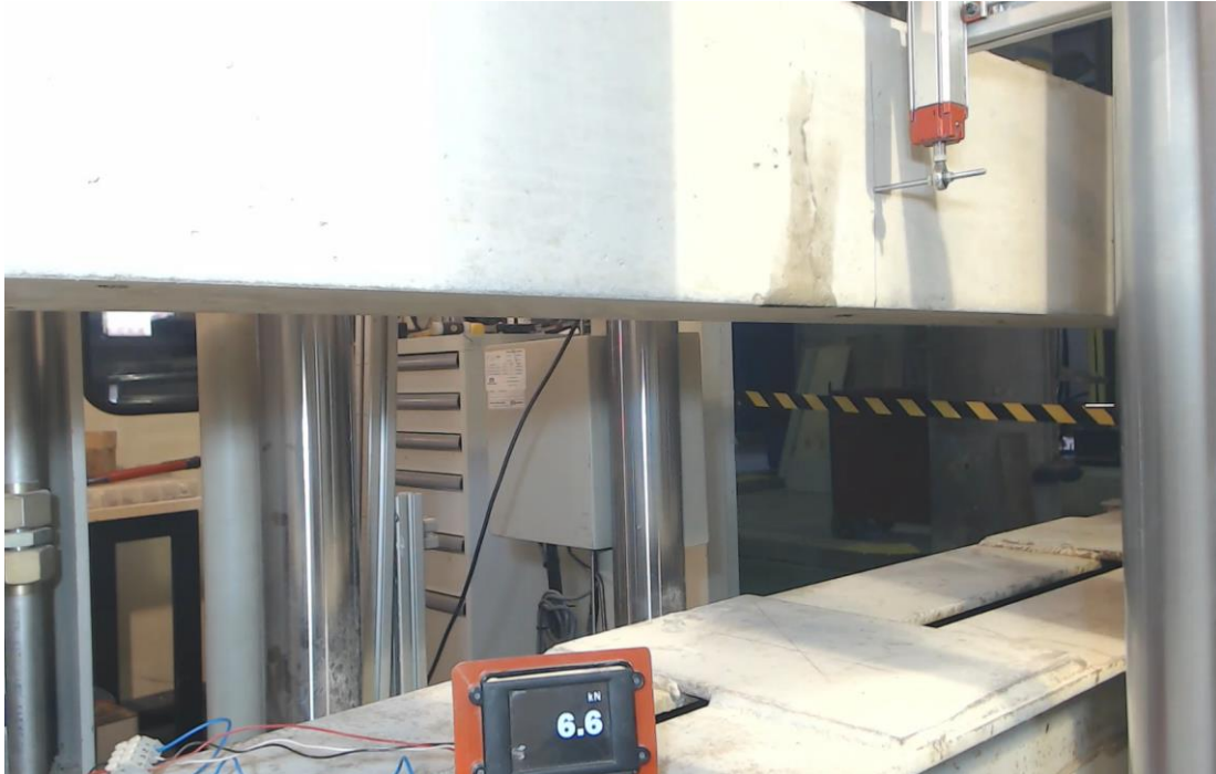
Figura 72. Fisuras Viga 3T13a a 6,6kN. Grupo 2.
