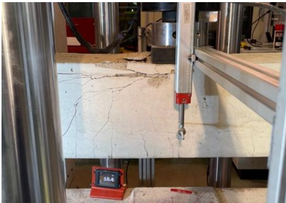
Figura 71. Fisuras de la Viga 3V13 a carga máxima. Grupo 2.
