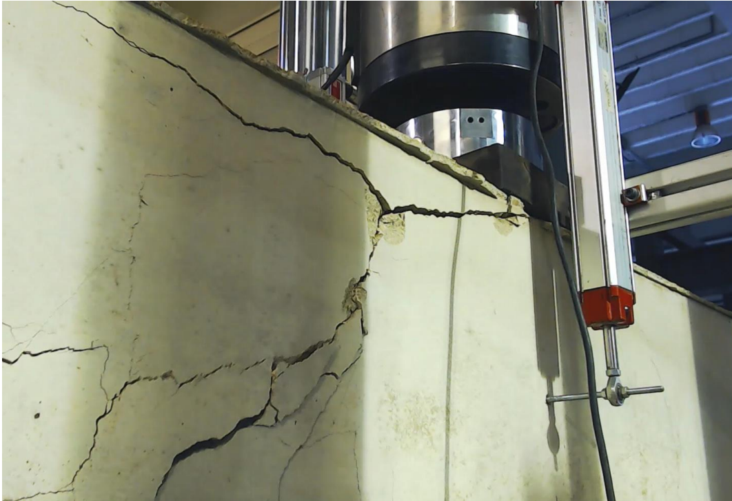
Figura 68. Fisuras Viga 5V10 a carga de rotura. Grupo 2.
