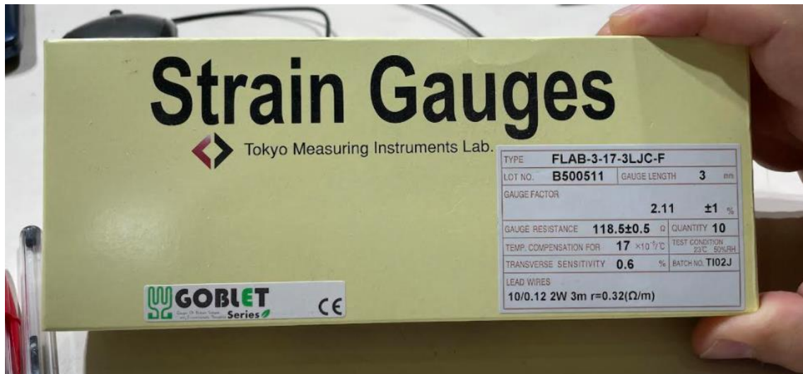
Figura 52. Información aportada por el fabricante de las Galgas Extensiométricas.
