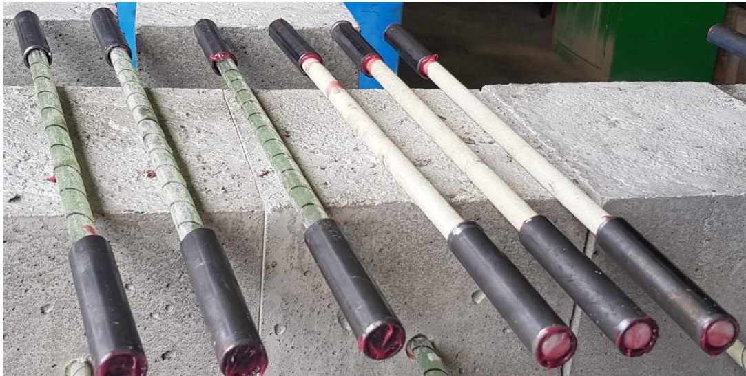
Figura 27. Barras FRP para caracterización del material, con las protecciones en los extremos. Fuente: TFM A.Moncayo 2021
