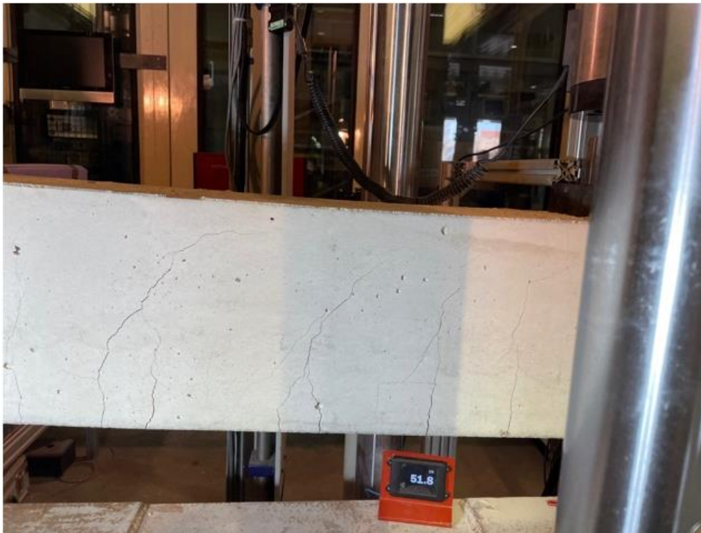
Figura 69. Fisuras Viga 3V13 a 51,8 kN. Grupo 2.
