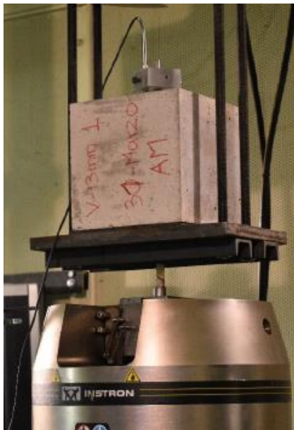
Figura 7. Fotografía del ensayo Pull-out. Fuente: A. MONCAYO (2021)
