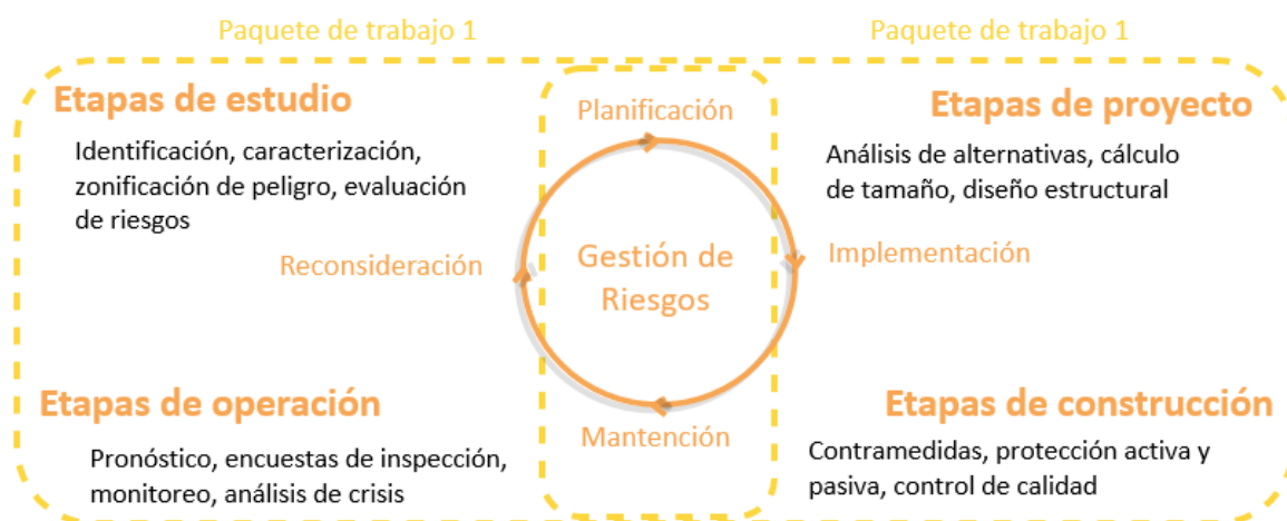
Figura 21. Diagrama de flujo para la gestión del riesgo de caída de rocas en el Montserrat desarrollado por el ICGC (Buxó, et al., 2017)
