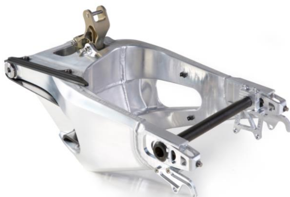
Il·lustració 9: Basculant d'alumini de secció variable (Font: Google imatges)
