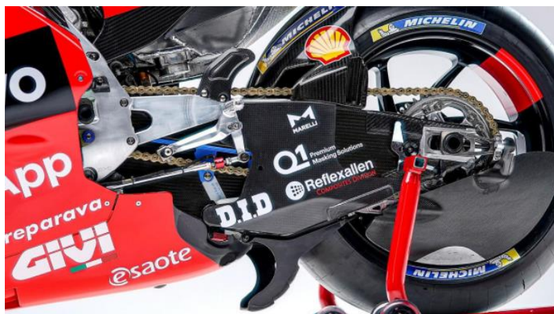
Il·lustració 10: Basculant de fibra de carboni de l'equip Ducati MotoGP (Font: Google imatges)
