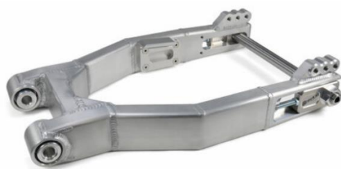
Il·lustració 6: Basculant clàssic amb perfils d'alumini (Font: Google imatges)
