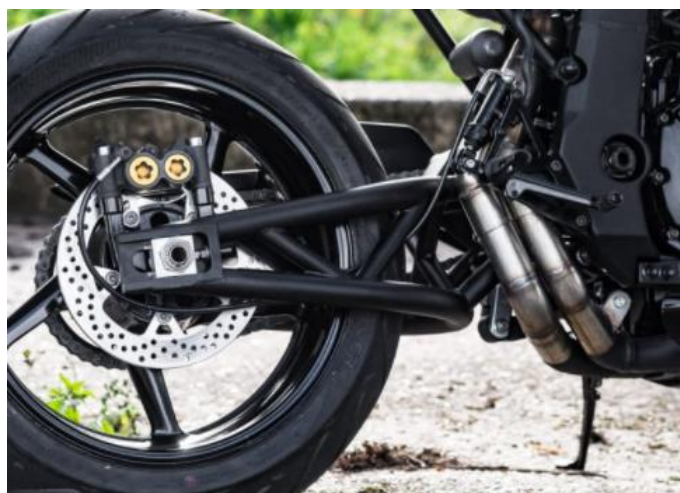
Il·lustració 8: Basculant tubular d'acer (Font: Google imatges)
