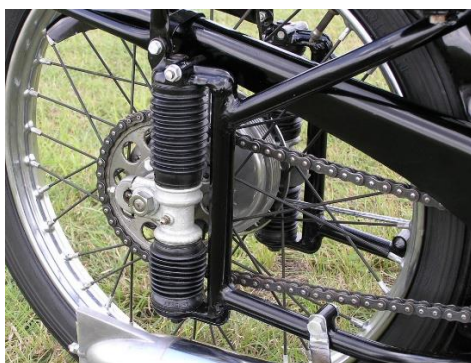
Il·lustració 2: Motocicleta amb sistema Plunger (Font: Google imatges)
