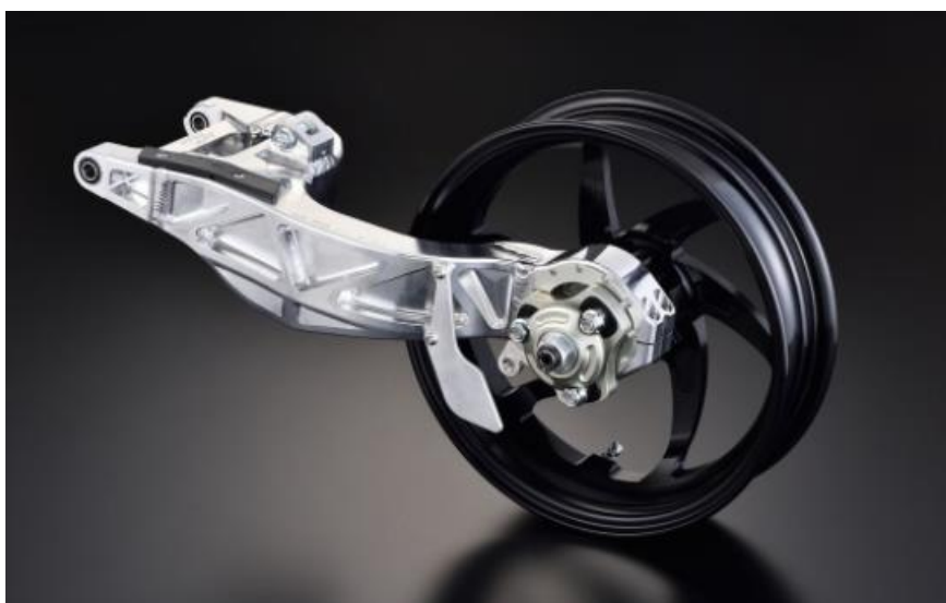
Il·lustració 11: Basculant amb estructura mono braç (Font: Google imatges)
