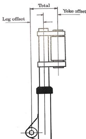
Il·lustració 14: Representació esquemàtica de l'offset de direcció (Font: ePowered Racing)
