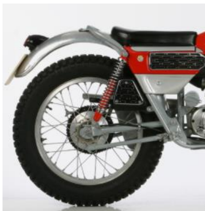
Il·lustració 3: Braç basculant amb suspensió tradicional (Font: Google imatges)
