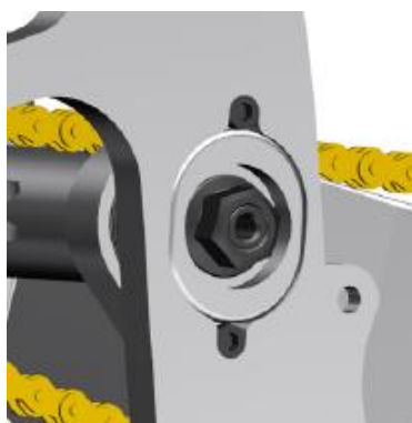
Il·lustració 35: Sistema de variació d'altura per eix de basculant (Font: ePowered Racing)
