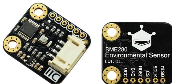
Figura 6.21.- Placa SEN0236, integra BME280 junto con otros componentes, vistas TOP y BOTTOM
