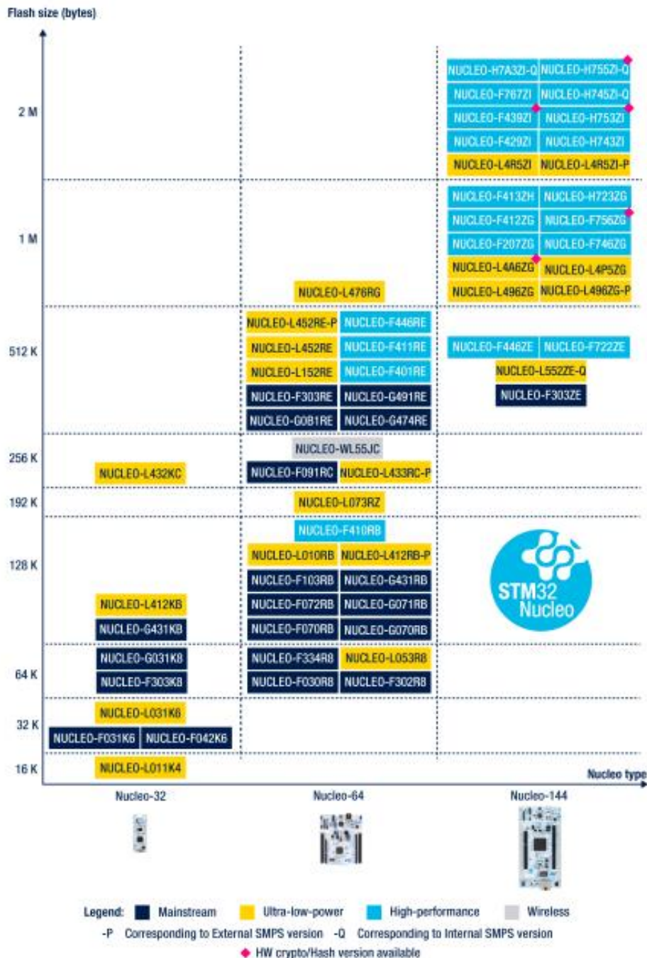
Figura 5.1.- Clasificación de las placas STM32 NUCLEO
