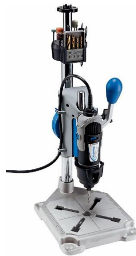
Figura 8.15.- Taladro vertical (Dremel) utilizada para taladrar la PCB
