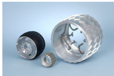
FIGURA 6.1: Rueda de Curiosity (sin agujeros en código Morse y sin el anodizado negro) comparadas con la de los MER
