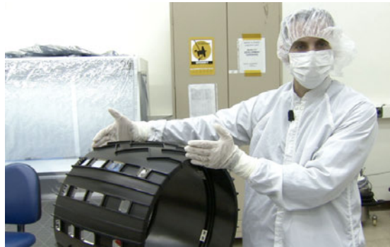
FIGURA 5.1: Rueda del Curiosity con los agujeros que indican el JPL en código Morse [63]
