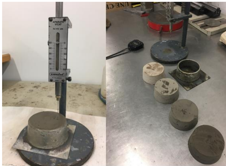
Figura 4. Ensayo de fraguado inicial y final durante y después de su realización. Fuente: toma propia en laboratorio de la UPC
