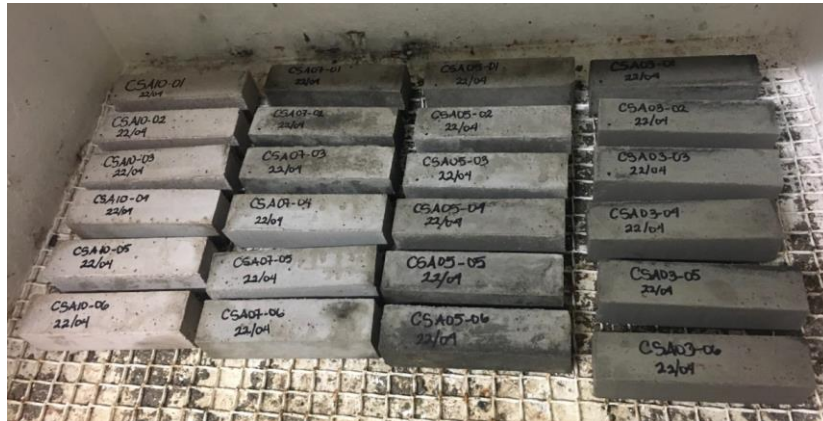
Figura 5. Morteros fabricados durante el curado con las designaciones de CSA/CV seleccionadas.
