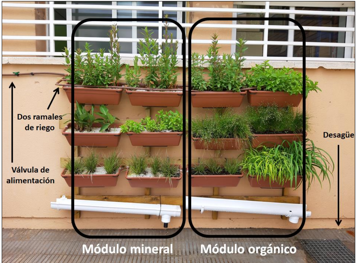
Figura 13. Sistema de macetas del piloto implementado en el Institut Les Salines para el tratamiento de agua gris
