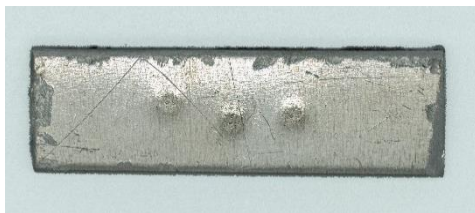
Figura 4.77. Imagen de una probeta en la que se muestra como el indentador ha marcado en exceso la superficie posterior.
