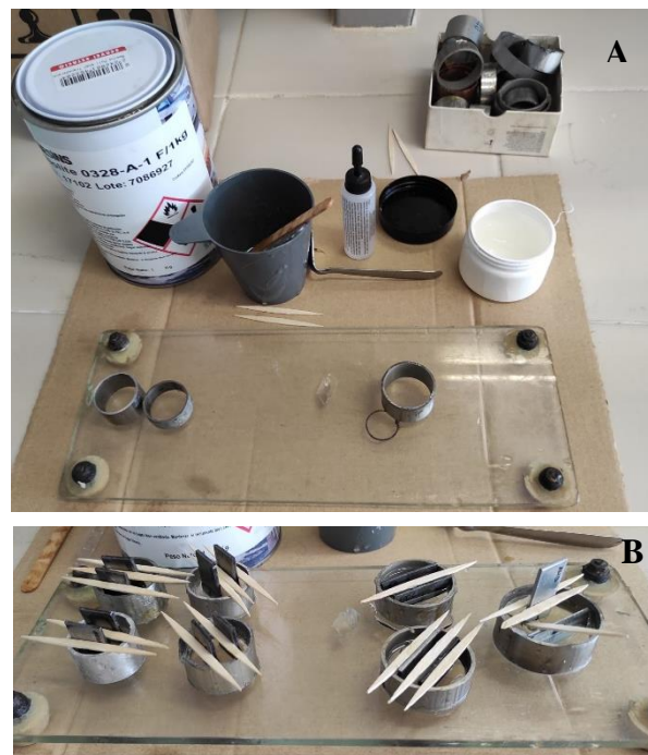
Figura 3.3. Proceso de embudo de las muestras para la metalografía. A) Materiales utilizados. B) Probetas embutidas en resina.
