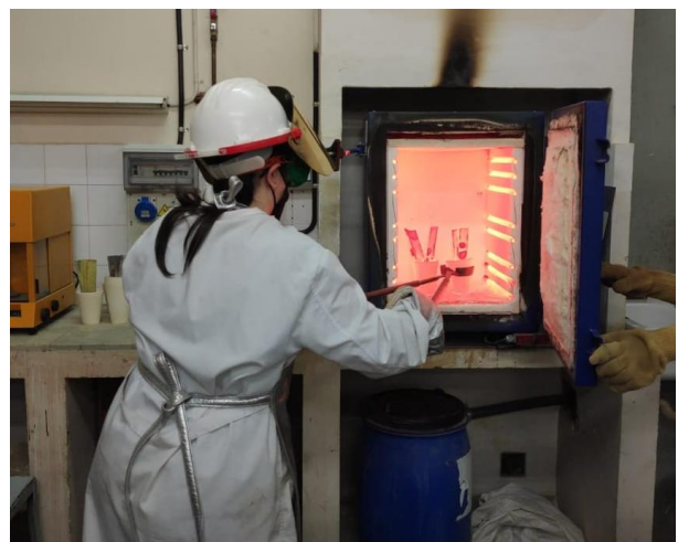
Figura 3.1. Proceso de introducción de las probetas en el horno.
