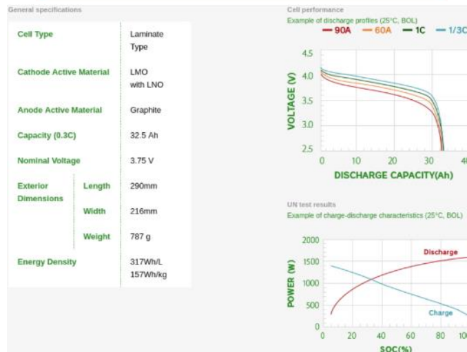
Ilustración 26 e Ilustración 27: Celda laminada y ficha técnica de celda laminada que utiliza el Nissan Leaf.
