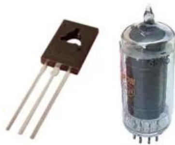
Figura 6: Transistors respecte vàlvules.
