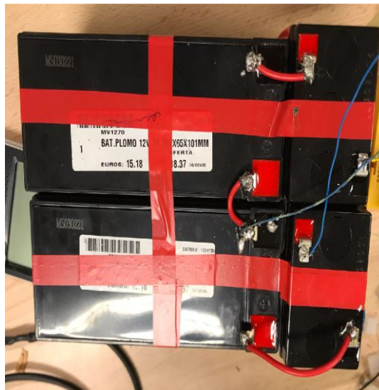
Figura 91: Bateries emprades per a la font d'alimentació.
