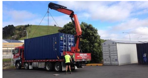
Figura 7: Camió grua pel transport de contenidors
