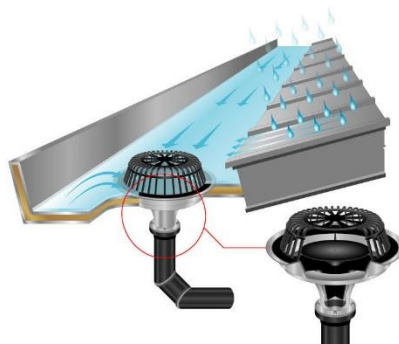
Figura 45: Sistema de drenatge sifònic per baixants
