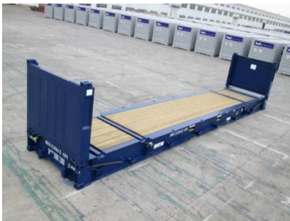
Figura 13: Exemple contenidor Flat Rack
