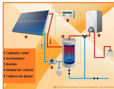
Figura 40: Sistema convencional de captació solar
