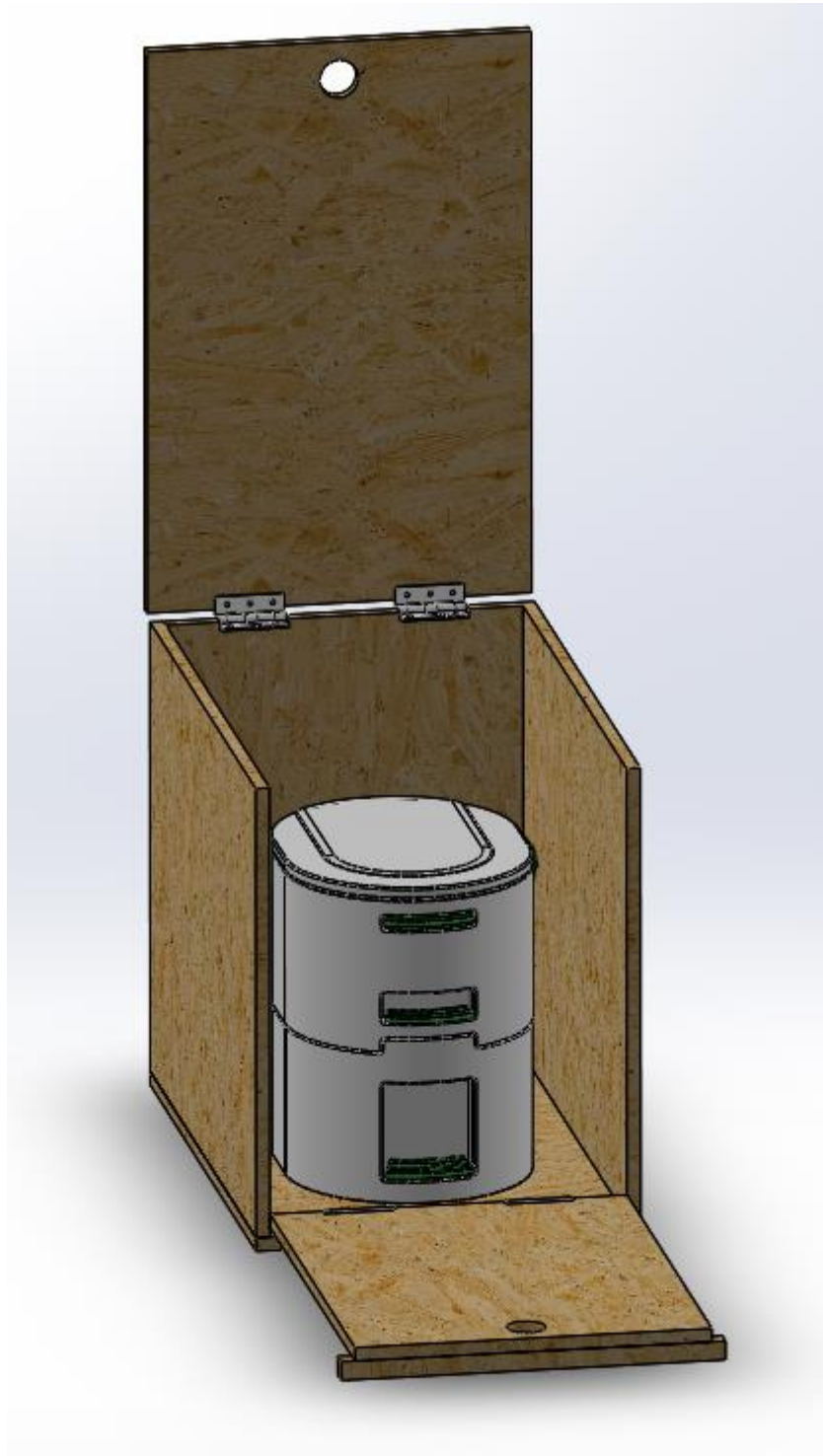
Il·lustració 4: Col·locació específica WC a l'armari dret.
