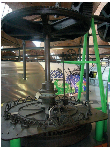
Figura 2: Turbina Fontaine fabricada a la casa Planas i Flaquer (mNACTEC).
