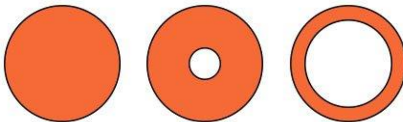
Figura 2.23: Efecte skin, (d'esquerra a dreta) decreixement de la secció per la que circulen electrons amb l'augment de la freqüència.
