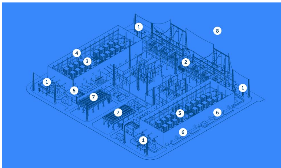
Figura 3.15: Esquema de les estacions de conversió de l'enllaç HVDC Baixàs-Santa Llogaia.
