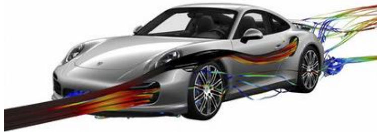
Figura 13. Representació gràfica de la distribució del flux per la carrosseria gràcies a l'efecte coanda. [12]
