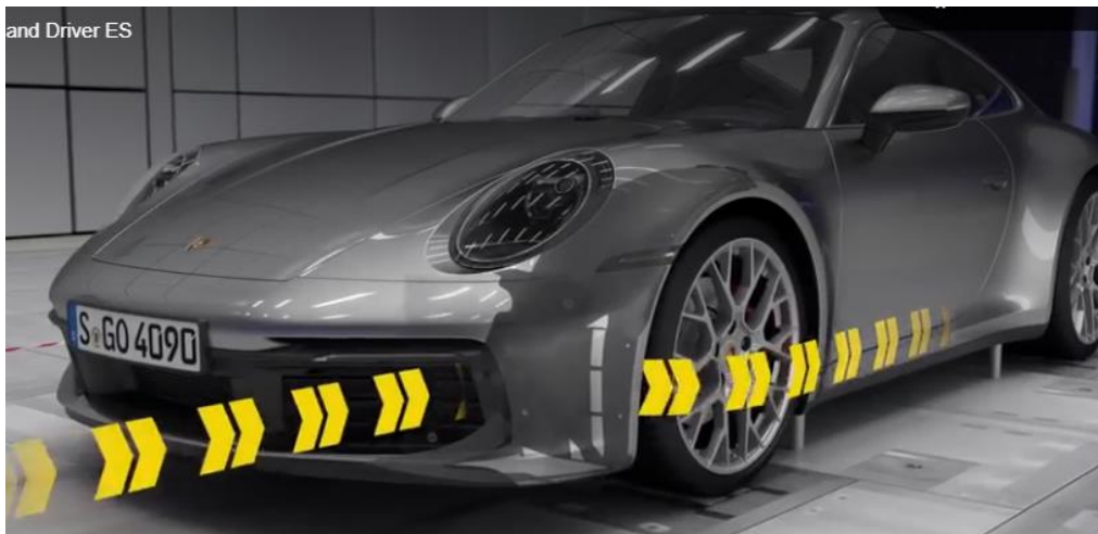
Figura 27. Representació gràfica de les línies de flux amb les obertures frontal obertes. [18]
