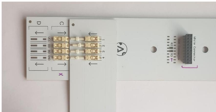
Figura 4.25. Unión real entre la PCB de conexión vertical y la PCB de conexión horizontal.
