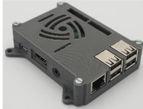
Figura 5.9. Raspberry PI modelo B con carcasa 3D.
