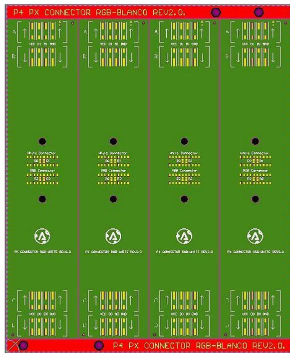
Figura 4.16. Panel de PCB de conexión vertical.
