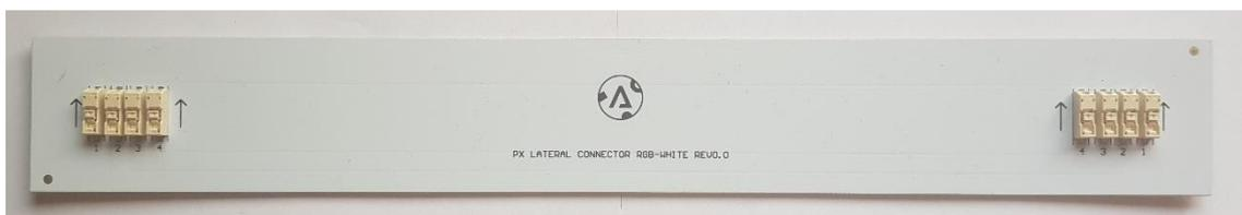
Figura 4.24. PCB de conexión horizontal completa.
