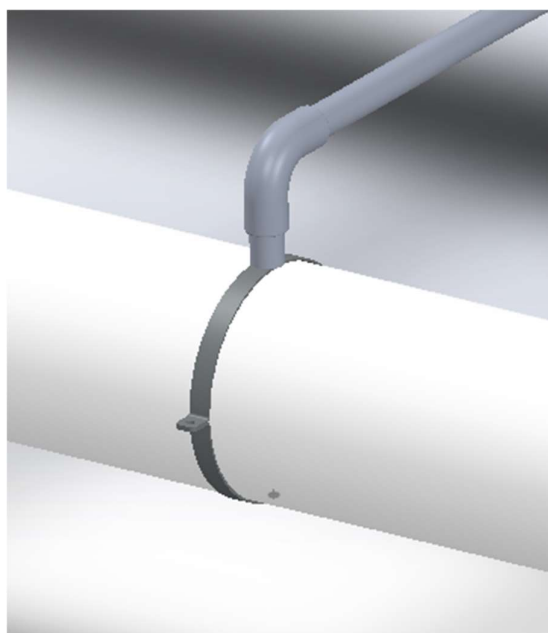
Figura 4-54 Método de agarre de estructura a flotador
