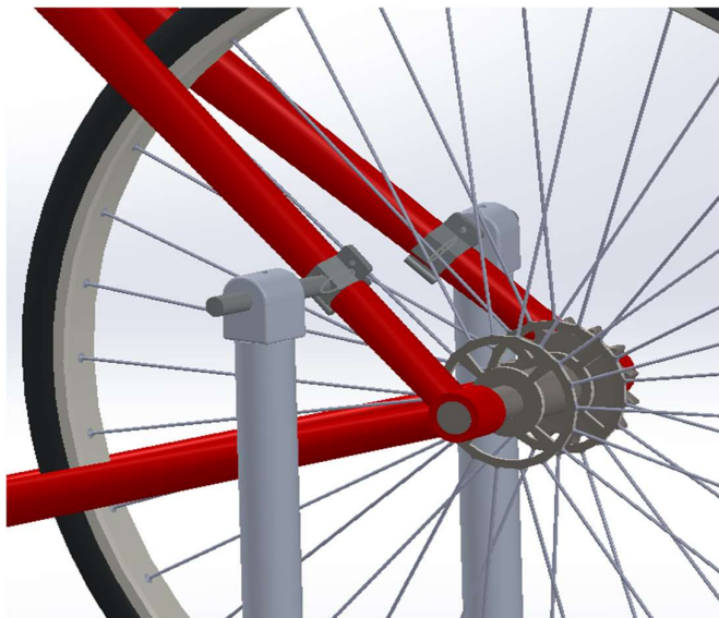
Figura 4-53 Método de agarre de estructura trasera al cuadro
