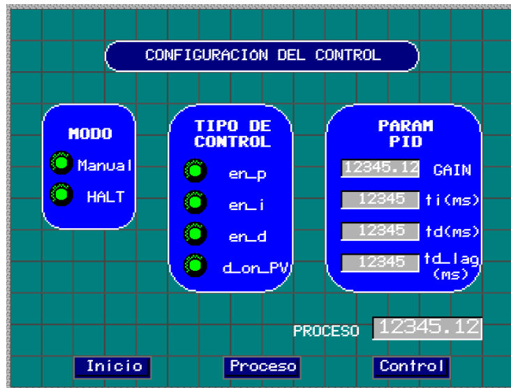
Figura 73. Pantalla de control vijeo
