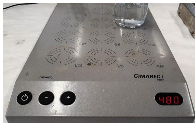
Imagen 3. Fotografía del agitador magnético con 15 posiciones CIMAREC i Poly . En el fondo del recipiente se observa la barra magnética que al moverse agita la mezcla
