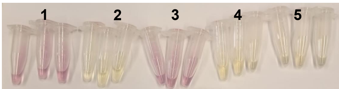
Imagen 13. Resultados de la técnica con DPPH. 1: control negativo (no reacciona), 2: control positivo, 3: HA sin modificar, 4: HA-DOPA con peso molecular de 60 kDa, 5: HA-DOPA con peso molecular de 200 kDa.
