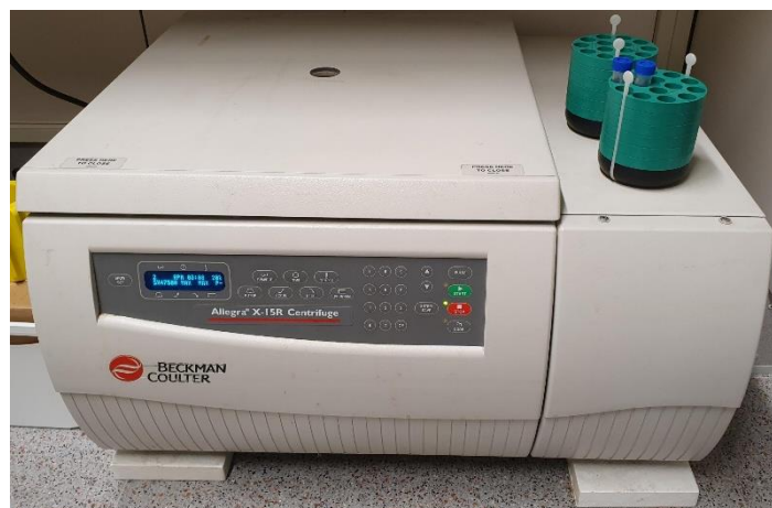
Imagen 5. Centrifugadora BECKMAN COULTER en la que se ha preparado la disolución de lacasa.
