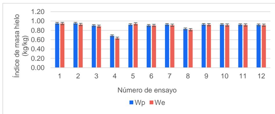
**Figura 8: Índice de masa del hielo experimental ( $W_e$ ) y teórico ( $W_p$ )**
