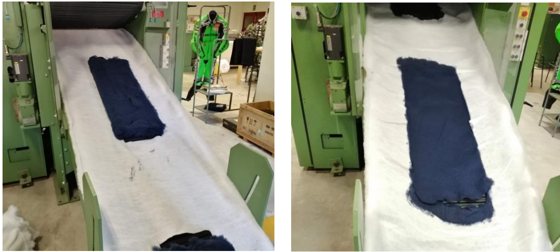
Figura 4.3. Napes entrant a la màquina punxonadora. A la fotografia de l'esquerra entrant per primera vegada, a la de la dreta per segona vegada. Font: pròpia.
