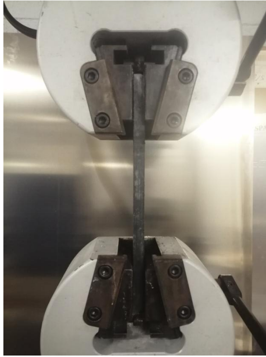
Figura 4.6. Provena col·locada a la UTM per ser assajada a tracció. Font: pròpia
