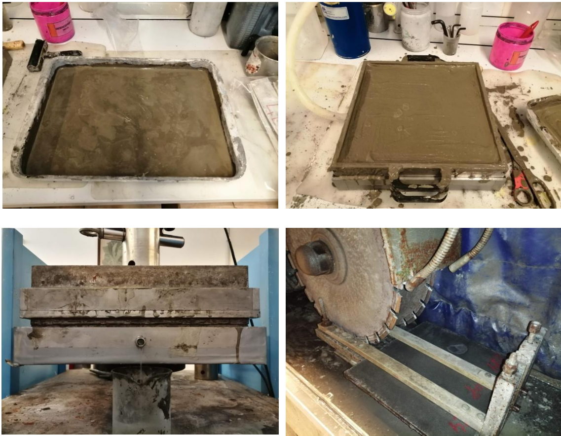
Figura 4.4. A dalt a l'esquerra safata amb el ciment diluït on es van impregnar les napes. A dalt a la dreta càmera de buit amb una capa de ciment a ja col·locada. A baix a l'esquerra premsa preparada per extreure l'aigua sobrant. A baix a la dreta serra amb que es van tallar les plaques. Font: pròpia.
