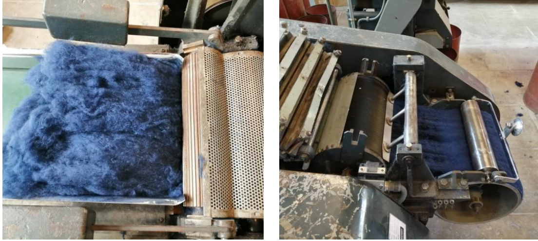
Figura 4.2. Triturat de fibra a l'entrada i sortida de la màquina de carda. Font: pròpia
