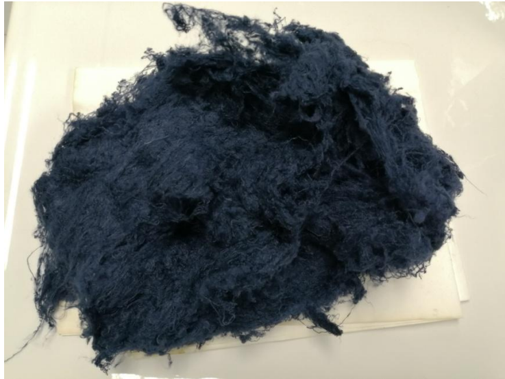
Figura 4.1. Triturat d'aramida procedent dels polos del cos de Bombers de la Generalitat de Catalunya. Font: pròpia.
