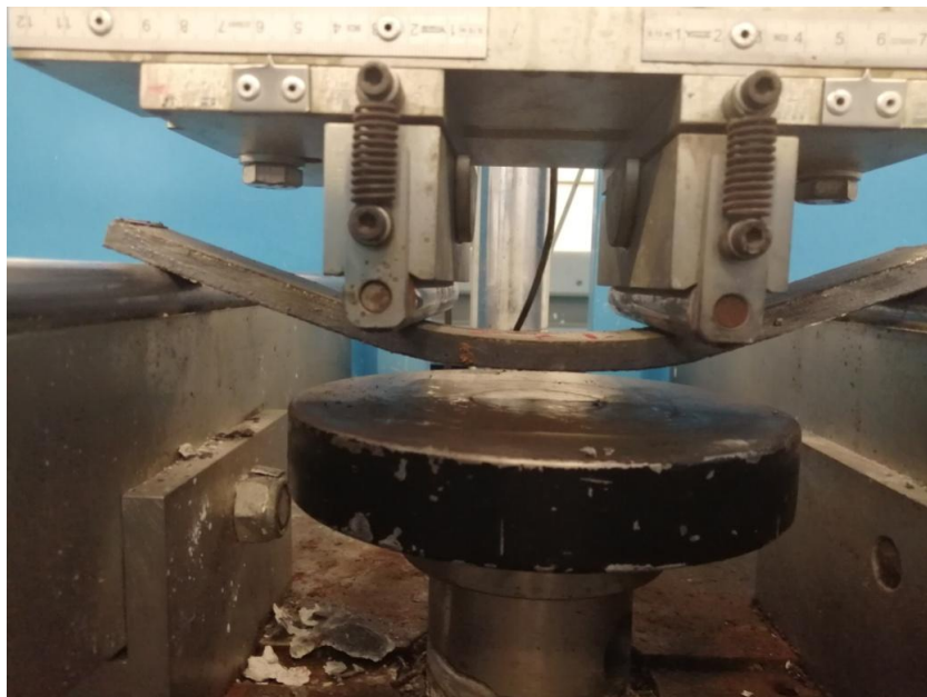
Figura 4.7. Provetta essent assajada a flexió. Font: pròpia.
