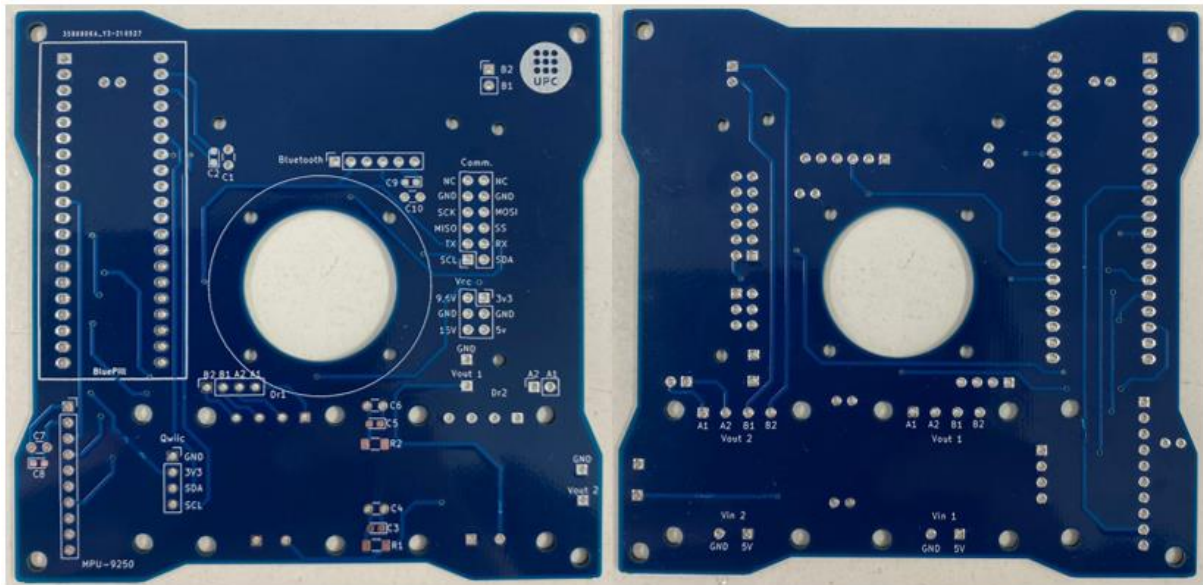
Ilustración 32: Resultado de la fabricación de la PCB. Cara superior en la izquierda e inferior en la derecha.
