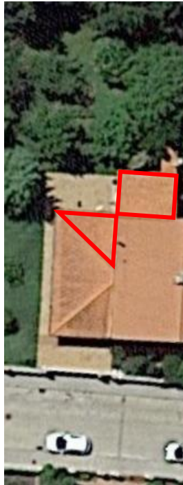
il·lustració 26: Situació dels panells solars fotovoltaics a la teulada
