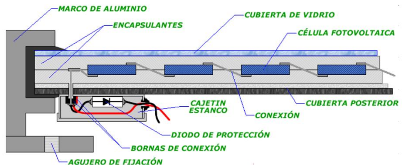
il·lustració 5: Components d'un mòdul fotovoltaic ( tall )
