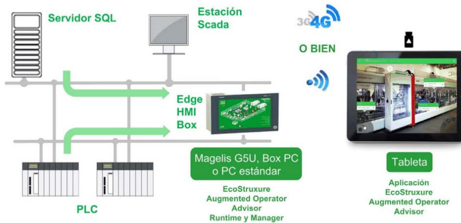
Ilustración 10: Diagrama de conexión. Fuente: Guía de Inicio rápido EcoStruxureAOA
